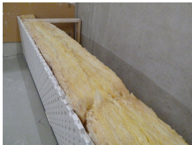
Kantenabsorber mit 50%iger Füllung aus Mineralfasermaterial
