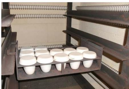
Abb. 2 Tiegelhalterung für den Glühofen
