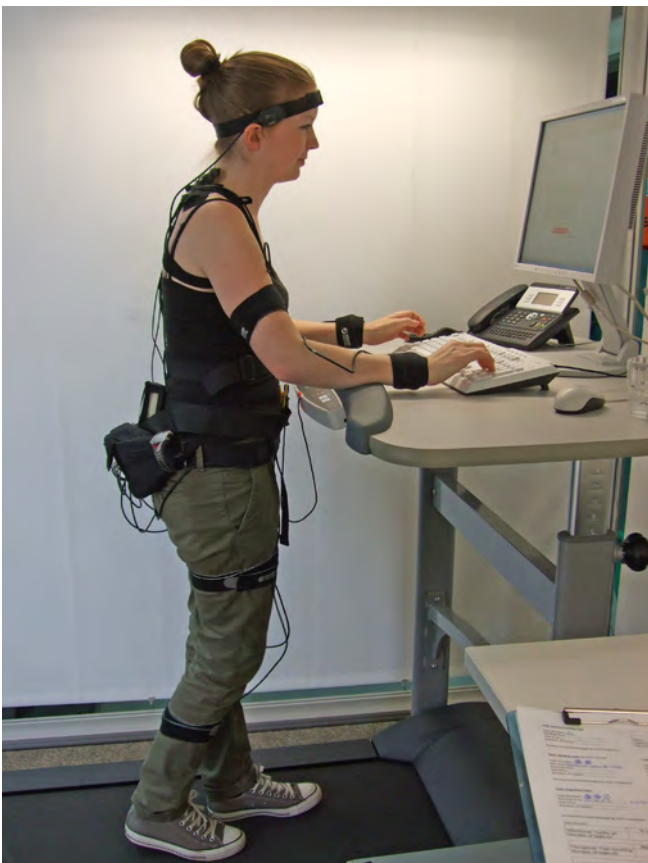
CUELA-Messungen an einem dynamischen Steharbeitsplatz mit Laufband
