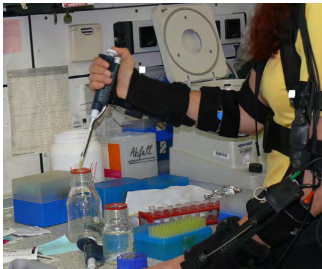
CUELA-Messung der Hand-Arm-Belastung beim Pipettieren
