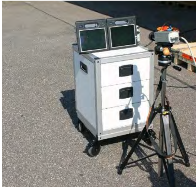
Messung der Displayqualität bei direkter Sonneneinstrahlung
