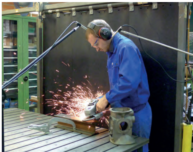
Lärmmessung beim Schleifen
