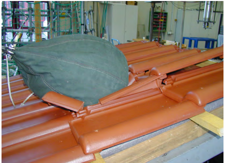
Aufbau als flach geneigtes Ziegeldach nach Fallversuch, Sack von 50 kg
