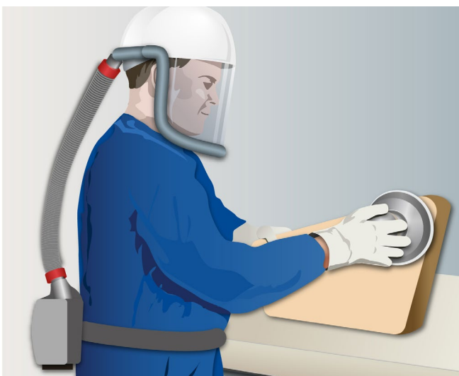
Abb. 15.2 Mitarbeiter trägt Filtergerät am Rücken, über Schlauchverbindung sind Helm und Haube angeschlossen
