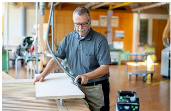
Abb. 12.6 Tischler bearbeitet Werkstück mit einem abgesaugten Handschleifklotz
