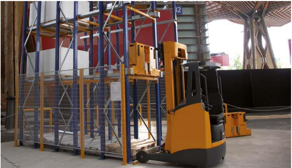
Abb. 2 Das Satellitenfahrzeug transportiert die Palette im Regalkanal unabhängig vom Stapler
