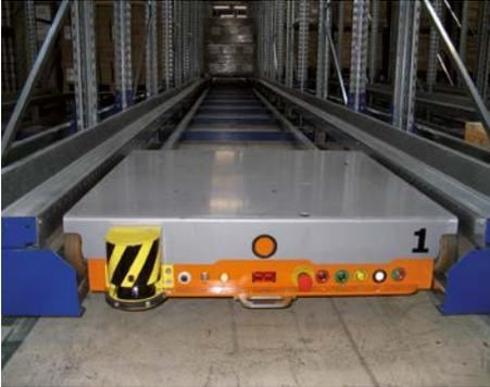
Abb. 5 Shuttle mit Sensor zur Personenerkennung (Laserscanner)
