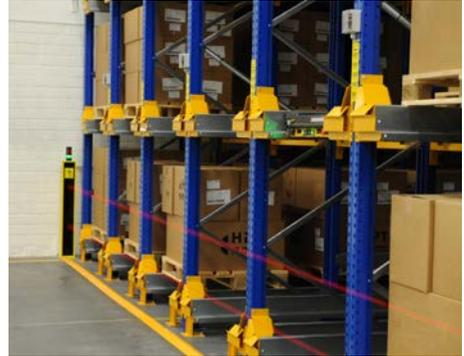
Abb. 6 Absicherung mit Lichtgitter
