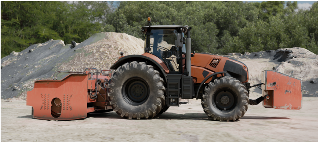
Abb. 2 Traktor mit Ballastierung und getragenen Anbaugerät
