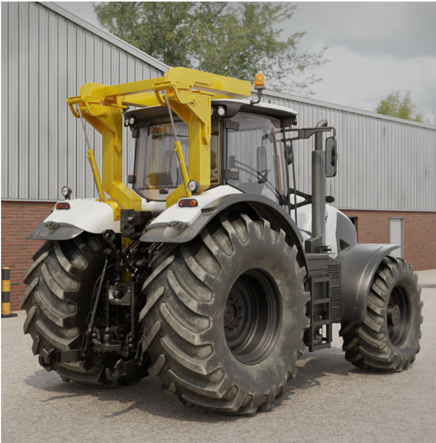
Abb. 3 Vom Hersteller angebotener zusätzlicher Überrollschutz (ROPS)
