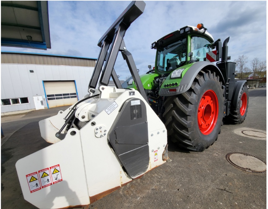
Abb. 4 getragenes Anbaugerät mit eigenem ROPS
