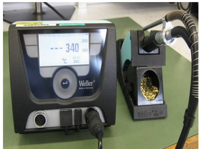
Abbildung 8: Lötstation, LötKolben mit Halter, Lötspitze und Lötdraht
