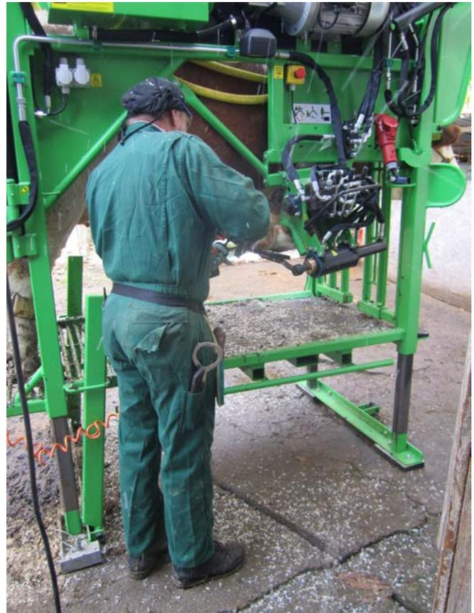
Abb. 12-1 Ein höhenverstellbarer Klauenpflegestand für eine ergonomische Arbeitsweise
