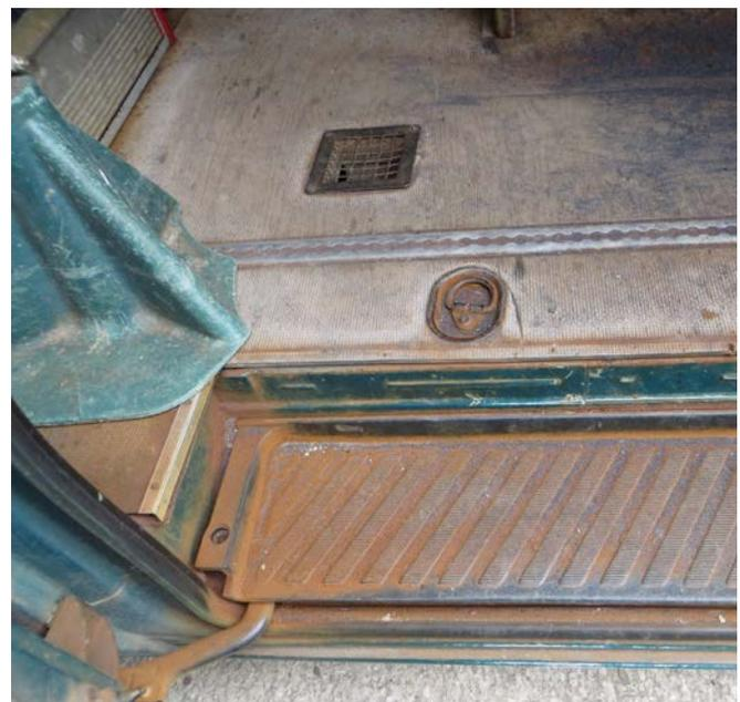
Abb. 9-1 Belüftungsöffnung im Fahrzeugboden
