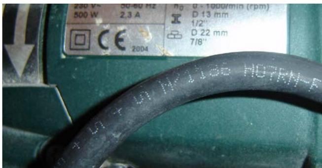
Abb. 5-1 Gummischlauchleitung
