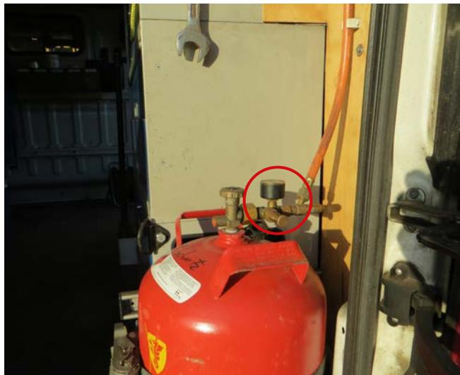
Sollte der Gasschmiedeofen nur unter direkter Aufsicht betrieben werden, das heißt, die Bedienperson steht immer unmittelbar daneben (Sichtkontakt!), sind keine weiteren Schutzeinrichtungen notwendig. Entfernt sich die Bedienperson aber während des Betriebs vom Ofen, um zum Beispiel in einer Stallgasse am Pferd zu arbeiten, müssen weitere zwei Schutzeinrichtungen vorhanden sein:
