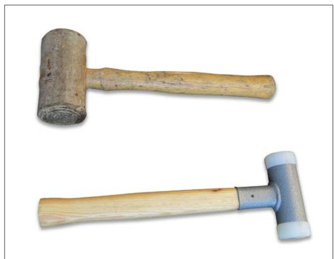
Abb. 2-1 Lederhammer und rückschlagfreier Hammer
