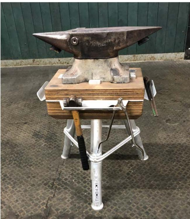
Abb. 3-2 Amboss mit Magneten zur Geräuschminderung
