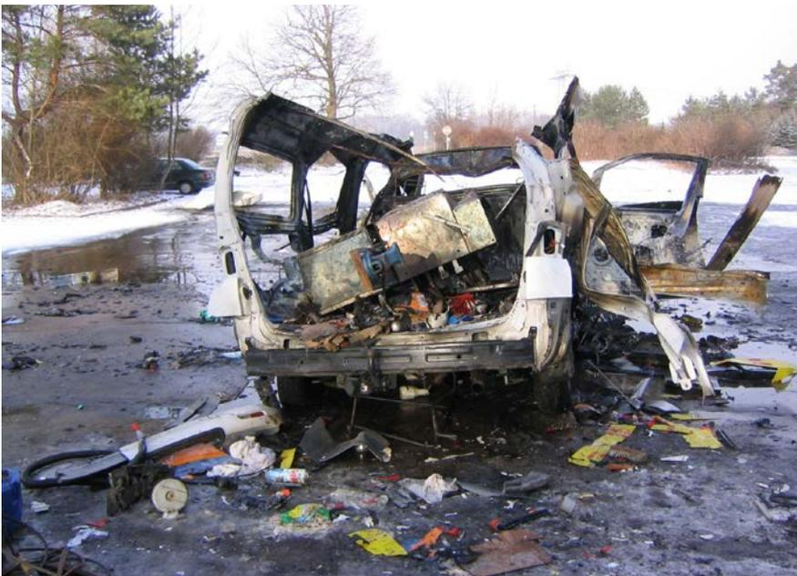
Abb. 9-2 Fahrzeug nach Druckgasflaschenexplosion
