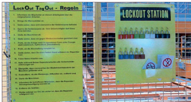
Die Abbildung zeigt die Lock Out-TagOut-Regeln an einer Maschine.
