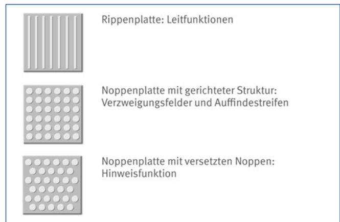
Abb. 8 Komponenten von taktilen Bodenindikatoren
