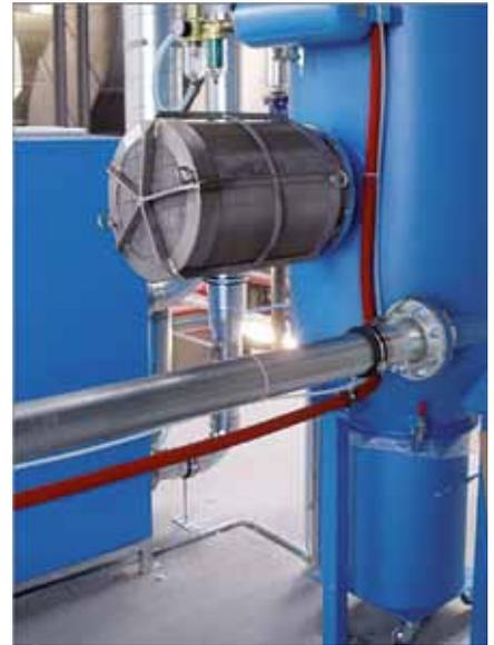
Die nach Öffnung der integrierten Berstscheibe austretenden Flammen werden über eine mehrlagige Edelstahl-Flammenfalle absorbiert (Kühleffekt).
