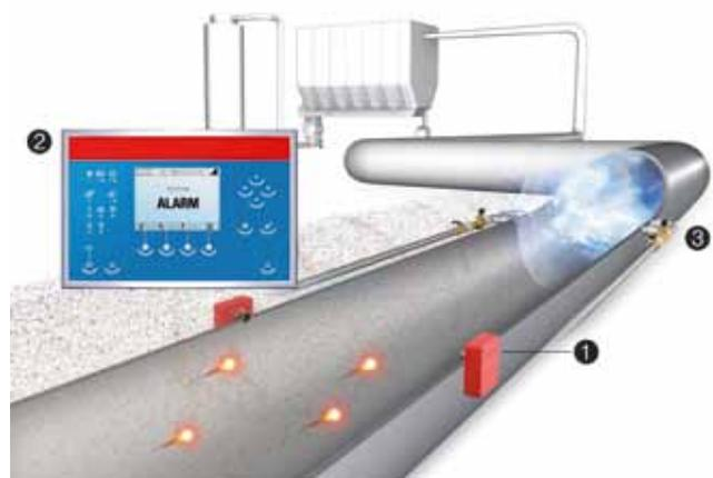
① Funkenerkennung ② Signalverarbeitung ③ Funkenlöschung
