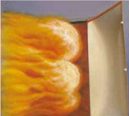
Müssen Behälter (Filteranlagen), die in geschlossenen Räumen aufgestellt sind, druckentlastet werden, so ist die **Druckentlastung über ein Abblasrohr** in „ungefährliche“ Richtung ins Freie zu führen. Durch den Einbau eines Abblasrohres erhöht sich bei gleicher Druckentlastungsfläche der reduzierte Explosionsüberdruck ( $p_{red,max}$ ) im Behälter. Dies muss bei der Behälterfestigkeit berücksichtigt werden (siehe Abschnitt „Einfluss von Abblasrohren“, Seite 46).
