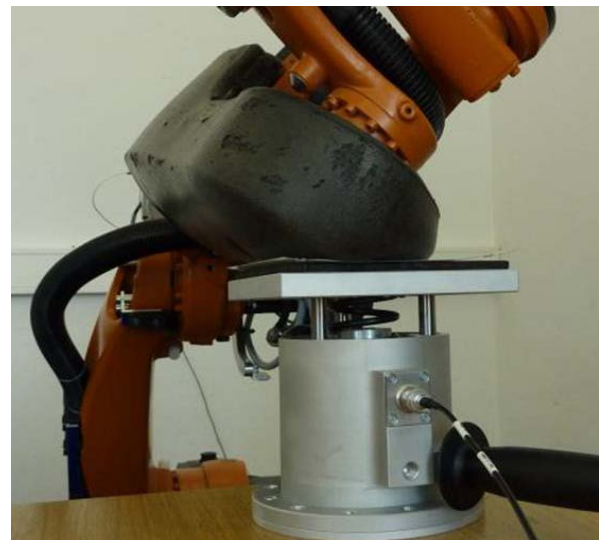
Roboter führt einen Stoß auf das Messgerät aus (Quelle: MRK-Systeme GmbH)
