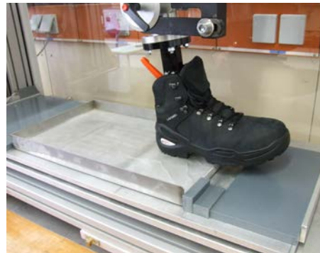
Bestimmung des Gleitreibungskoeffizienten nach DIN EN ISO 13287, Verfahren A/C-Ferse-Vorwärtsgleiten
