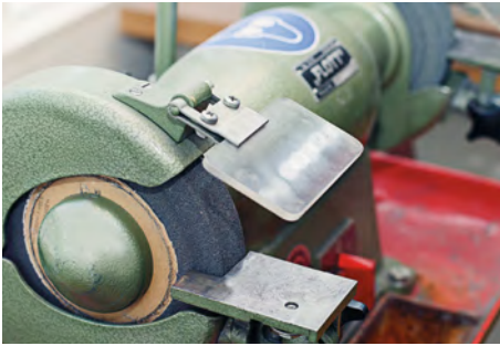
Schleifbock mit Schutzhaube und Fenster aus nichtsplitterndem Glas
