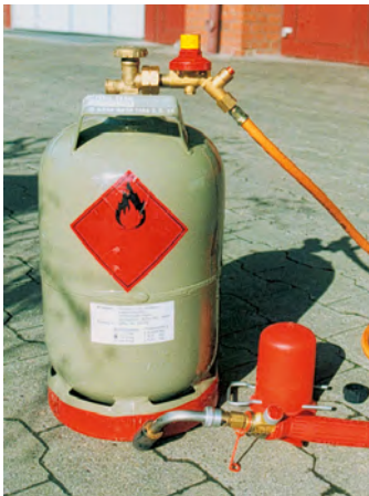
Flüssiggasflasche mit Verbrauchseinrichtung
