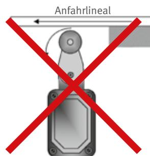
Abb. 43 Falsche Formgebung des Steuerlineals bei Rollenschwenkhebelschaltern
