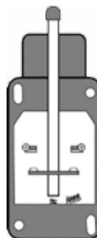
Selbst bei gebrochener Feder wird der Öffnerkontakt durch Betätigen des Schalters zwangsläufig geöffnet
