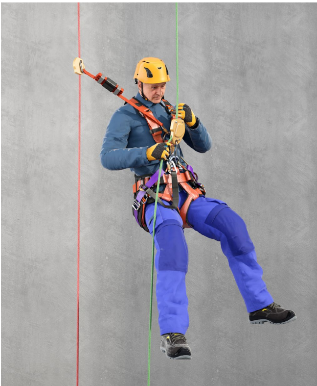
Abb. 4 Beispiel eines geeigneten Auffanggurt
