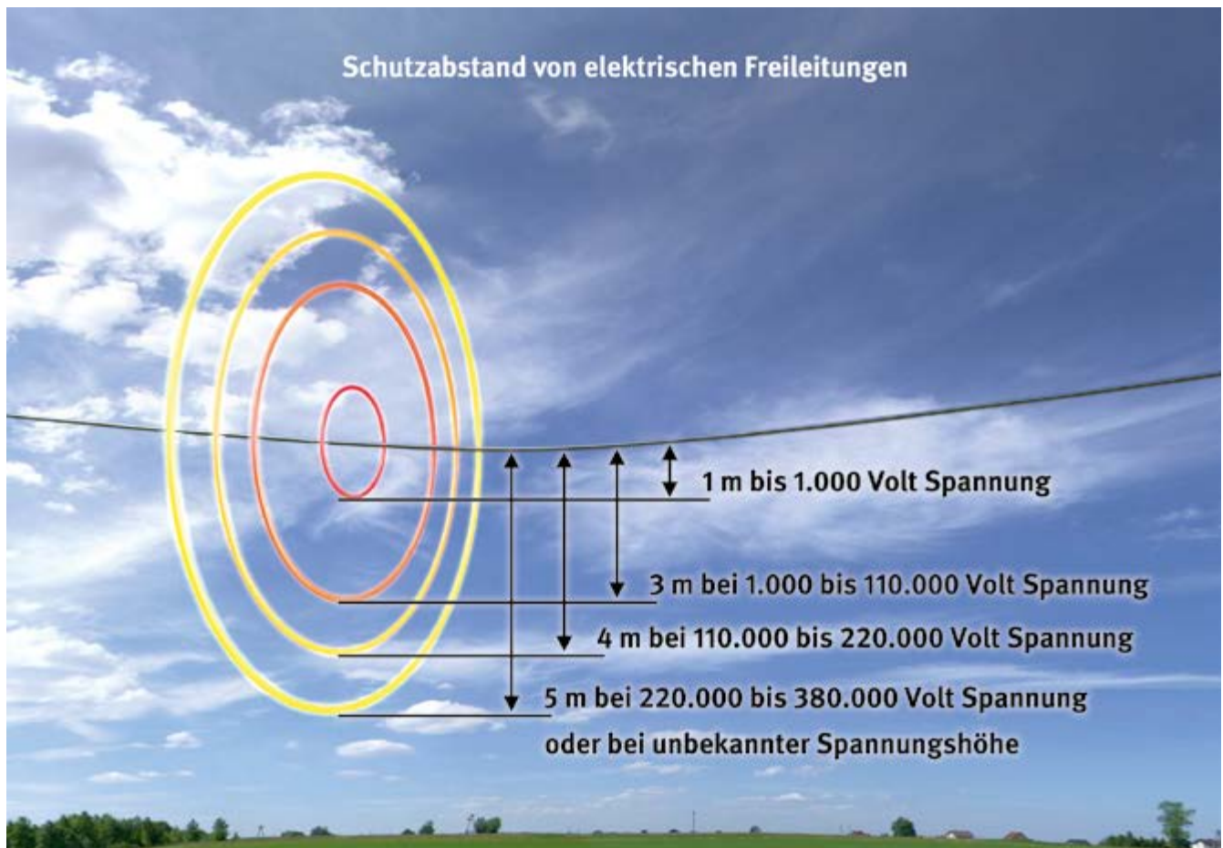
Abb. 23 Schutzabstände, hier z. B. bei einer Freileitung
