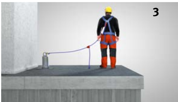
Abb. 1 Rangfolge der Schutzmaßnahmen gegen Absturz in prinzipieller Darstellung
