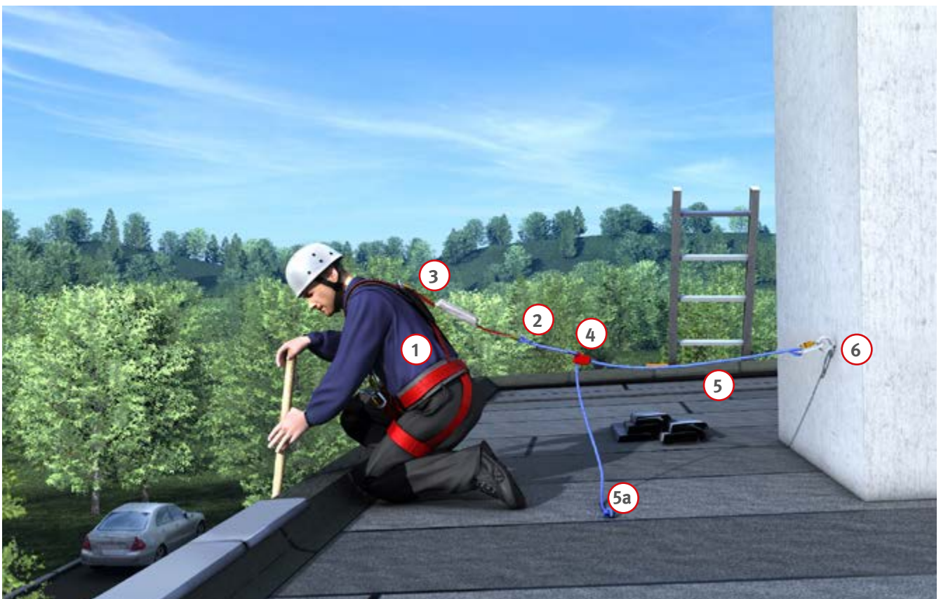
Abb. 6 (1) Auffanggurt, (2) Verbindungsmittel, (3) Falldämpfer, (4) mitlaufendes Auffanggerät, (5) bewegliche Führung (z. B. Seil, Band), (5a) Seilensicherung Die bewegliche Führung (5) muss am mitlaufenden Auffanggerät so eingestellt werden, dass ein Absturz nicht möglich ist. (6) Anschlagpunkt
