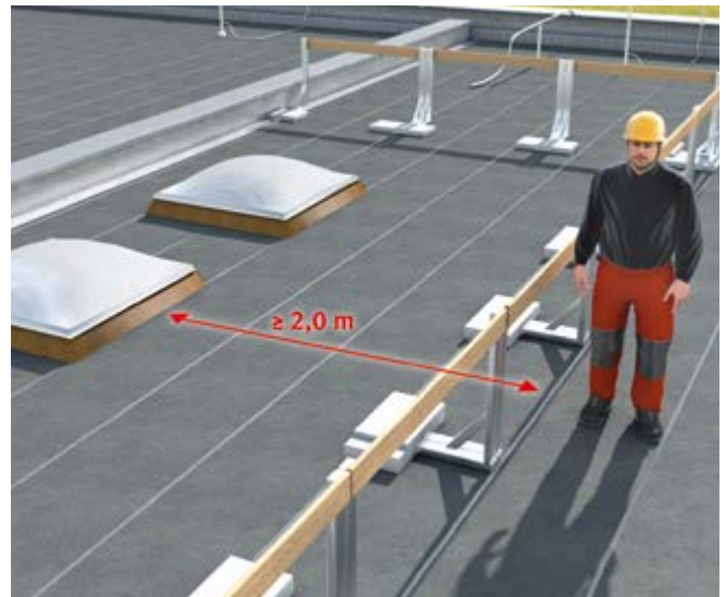
Abb. 5 Abspernung mehrerer Lichtkuppeln
