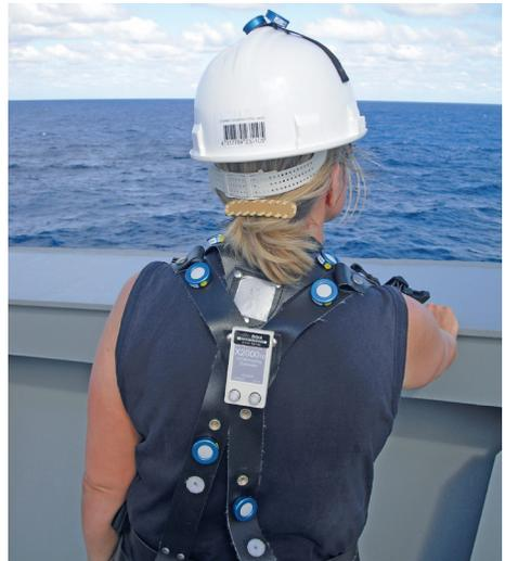
Die stationären und personengebundenen Messungen fanden täglich über einen (Arbeits-)Zeitraum von acht Stunden statt. Nach Schichtende wurden die von den X2000-10-Dosimetern im Minuten- bzw. im Zehnminutentakt aufgezeichneten Messwerte ausgewertet. Anhand dieser Werte konnte abgeschätzt werden, ob ein Austausch der VioSpor-Dosimeter erfolgen musste. Da diese Dosimeter nur über einen bestimmten Messbereich verfügen, der nicht
