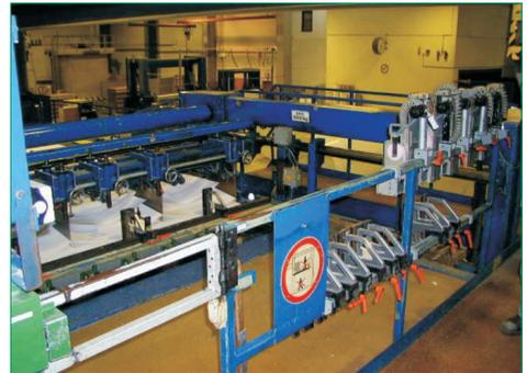
**Bild 12** Der Zugang zur ausfahrbaren Plattform wird durch eine verriegelte Tür mit Zuhaltung verwehrt, wenn die Höhe zwischen Hubbühne und Plattform mehr als 600 mm beträgt. Im Bild ist die Hubbühne oben, der Zugang ist also möglich.
