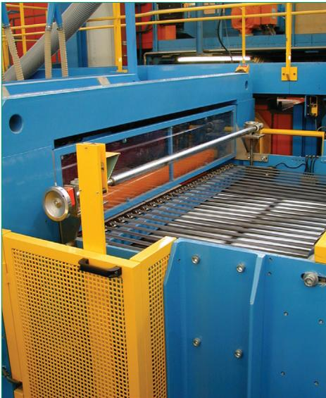
**Bild 8a** Querschneideaggregat mit Schutzvorrichtung aus Acrylglas und elektrisch verriegelter Zugangstür
