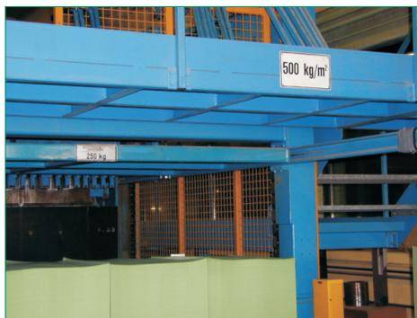
**Bild 1** Auch wenn die Verpflichtung besteht, die Belastungsangabe in der Betriebsanleitung anzugeben, für den Benutzer ist eine Angabe an der Bühne selbst sicher die bessere Lösung.
