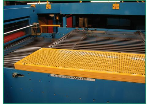
**Bild 10** Durch Zugriffshindernis geschützte Auflaufstellen an der Bänderpartie. Die Schutzeinrichtung ist hier zu klein dimensioniert. Die Auflaufstellen sind durch Übergreifen noch erreichbar, da die erforderlichen Sicherheitsabstände nach EN 294 nicht eingehalten sind.
