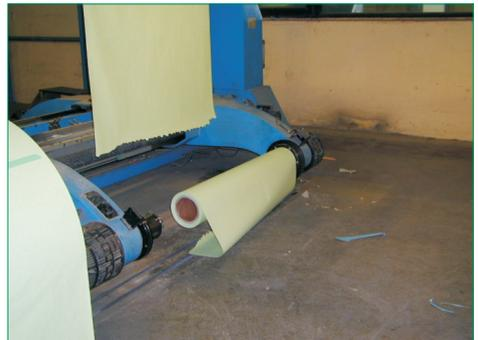
**Bild 5** Das Ablegen der Restrolle aus der Abwicklung erfolgt automatisch. In diesem Fall ist die Hülse auf dem Konus stecken geblieben. Der Operator muss in den durch Lichtschranken gesicherten Bereich hineingehen, um zu entstören. Solange er sich im Gefahrenbereich aufhält, dürfen keine gefährbringenden Bewegungen möglich sein.
