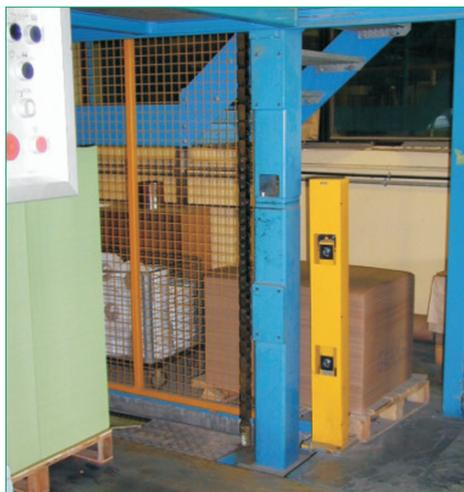
**Bild 15** Der Zugang zum Bereich unterhalb der Hubbühne ist seitlich durch Schutzgitter sowie an der Palettenausfahrseite durch Lichtschranken gesichert. Nach Auslösen der Lichtschranken muss erst vor Ort eine Quittierung vorgenommen werden, bevor die Bühne wieder verfahren kann.
