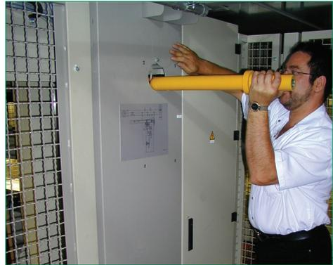
**Bild 18** Zwei Bolzen, die durch Stuhlungsöffnungen gesteckt werden, verhindern das ungewollte Absenken der Hubbühne im Fehlerfall.
