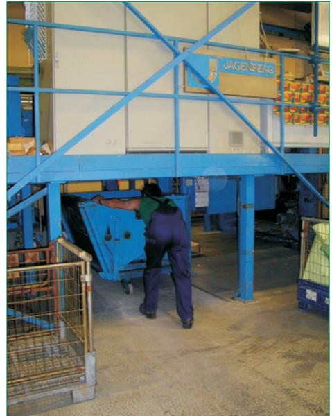
**Bild 4** Der Zugang zu einem Rollcontainer unter der Ausschussschleuse ist hier nur in gebückter Haltung möglich. Eine Polsterung der Laufstegunterkante fehlt ebenso wie eine Kennzeichnung der Stoßstelle.
