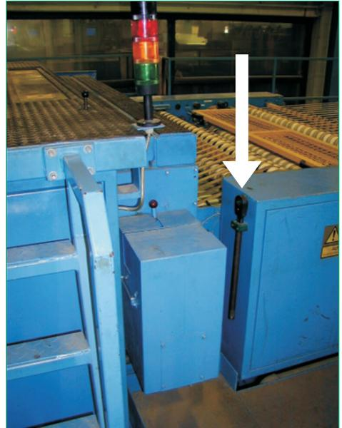
**Bild 2** Die Haube über dem Quermesser dient sowohl als trennende Schutzrichtung gegen Zugriff zum Messer wie auch als Lärmschutzhaube. Die rechts am Schaltschrank befestigte Ratsche (Pfeil) dient dazu, bei abgefahrenem Gehäuse (Bildmitte) das Quermesser von Hand in eine gewünschte Position zu drehen, z. B. zum Entstören oder zum Messerwechsel.
