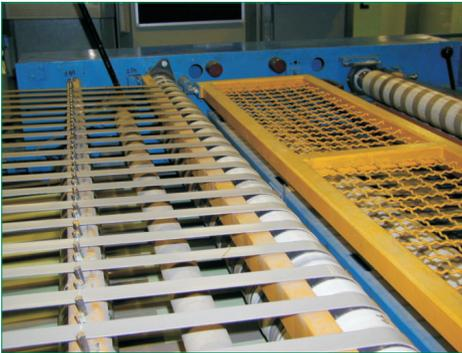
**Bild 9** Ein Schutzwinkel über die gesamte Maschinenbreite sichert die Auflaufstellen der Gurte auf die Umlenkwalze.
