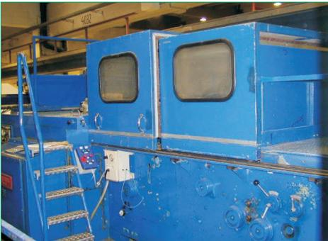
**Bild 3** Mit dieser zweiteiligen, verfahrbaren Haube lässt sich der Lärm wirkungsvoll dämmen.
