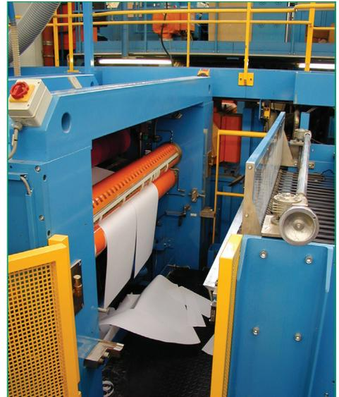
**Bild 8b** Zugang zum Querschneideaggregat nach Zurückfahren von Teilen der Bänderpartie bei Stillstand des Quermessers
