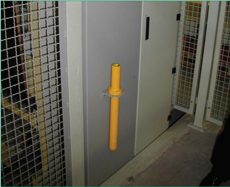
**Bild 19** Bolzen griffbereit in Halterung an der Maschinenstuhlung eingesteckt.
