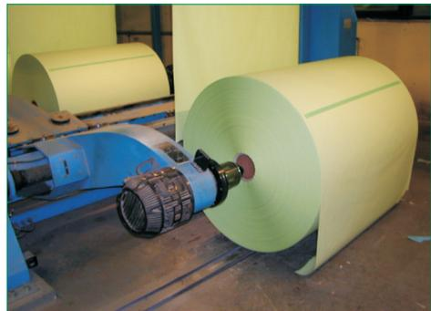
**Bild 6** Die Spannkonen fahren automatisch in die Hülse und nehmen die Rolle auf. Tritt ein Mitarbeiter dabei in den Gefahrenbereich, wird die Verfahrbewegung der Spannkonen stillgesetzt und kann erst nach Quittierung wieder eingeschaltet werden. Vorfahrbewegungen im Tippbetrieb sind jedoch vor Ort weiter möglich.
