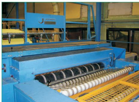
**Bild 7** Die Kombination bewegliche Acrylglasabdeckung mit klappbarem Laufsteg entspricht den Anforderungen an eine verriegelte trennende Schutzeinrichtung, wenn der oder die Grenztaster nicht mit einfachen Mitteln unwirksam gemacht werden können.
