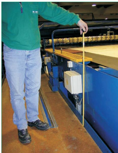
**Bild 11** Die Höhe beträgt mehr als 400 mm, ein Schutz gegen Sturz auf die Maschine ist nicht erforderlich.
