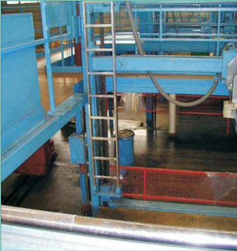
**Bild 13** Der Zugang zur mit der Hubbühne mitfahrenden Leiter ist nur möglich, wenn die Bühne steht oder sich betriebsmäßig mit einem wachsenden Stapel absenkt. Beim Hochfahren oder schnellen Absenken wird der Zugang durch die verriegelte Tür mit Zuhaltung verwehrt.
