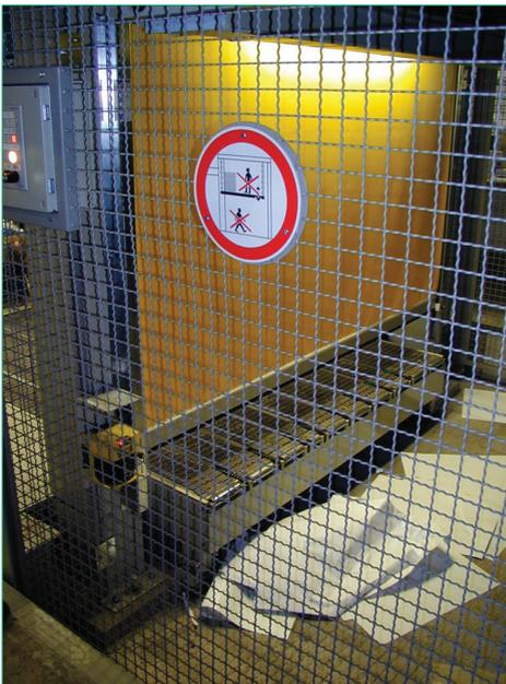
**Bild 16** Bei geöffnetem Rolltor erkennt der Laserscanner in den Bereich unterhalb der Hubbühne eintretende Personen.
