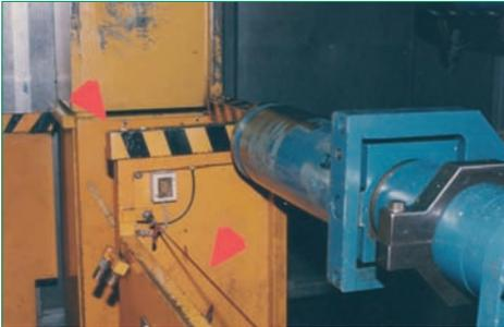
**Bild 9** Weiteres Beispiel einer Sicherung von Quetschstellen zwischen Fahrbühne und festen Teilen der Umgebung durch Schaltseil bzw. Schalleiste.
