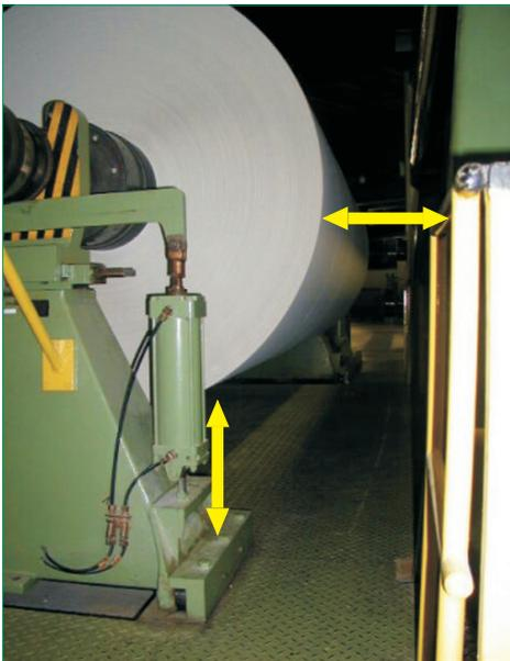
**Bild 2** Einzugsgefahr besteht nicht, wenn zum Boden sowie zu Stuhlungsteilen 500 mm Sicherheitsabstand eingehalten sind.
