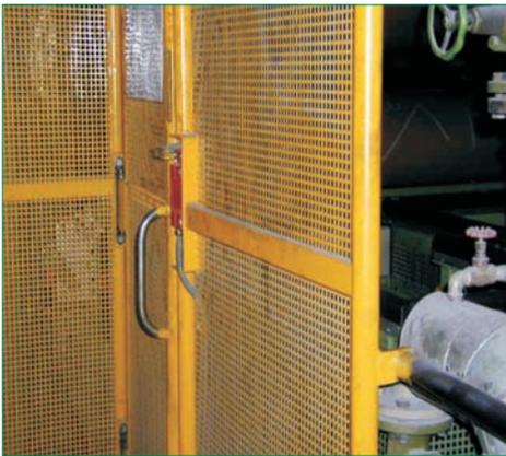
**Bild 7** Die Tür dient als Zugang zu der Fahrbühne eines Kalenders von einem ortsfesten Podest aus. Sie lässt sich jedoch nur öffnen, wenn sich die Bühne auf dem gleichen Niveau wie das Podest befindet.
