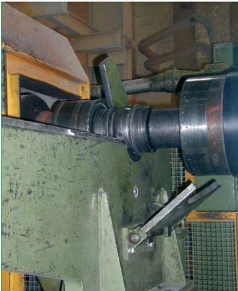
**Bild 1** Da die Kupplung noch greift, verhindert die Klappe das Einhängen des Kranhakens. Erst wenn sie getrennt hat, liegt die Klappe an der Stuhlung an und der Haken kann am Tambour eingehängt werden.
