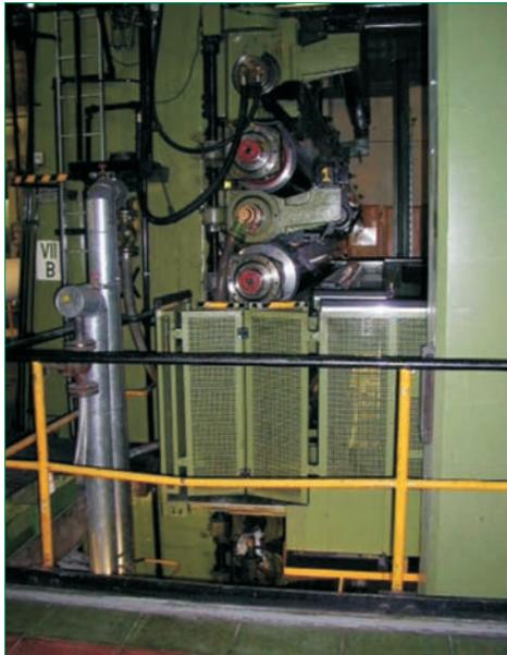
**Bild 14** Die Walzenwechselbühne ist ausgefahren, so dass Zugang zu den Walzenlagern besteht. Die Fahrbühne ist verriegelt. Muss sie auf eine andere Höhe gebracht werden, ist zuerst die Wechselbühne wieder einzufahren.
