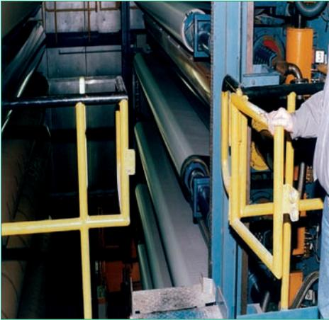
**Bild 8** Nicht mehr Stand der Technik an Fahrbühnenzugängen ist die Zugangstür ohne elektrische Verriegelung und Zuhaltung auch wenn ein Zugangspodest hinter der Zugangstür vorhanden ist
