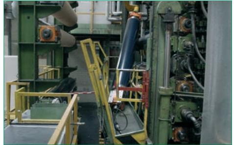
**Bild 16** Durch möglicherweise nicht sorgsam angebrachte Aufsteckhülse herabgefallene Walze
