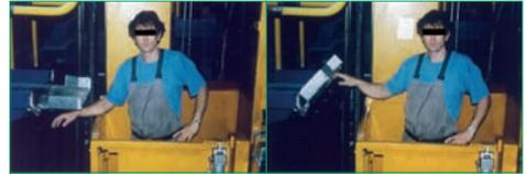
**Bild 10** Vermeiden von Quetschgefahren an der Fahrbühne durch eine bewegliche Zugangsklappe
