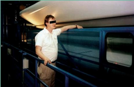
**Bild 5** Kalandr ohne Schutzstange mit Schutzgitter an der Fahrbühne
