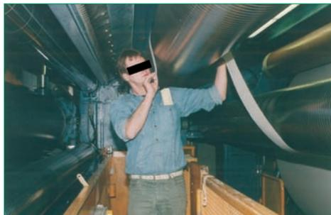
**Bild 20** Innenfahrbühne in oberer Position beim Aufführen der Bahn. Das Abschlagmesser ist in Parkstellung gegen Berühren gesichert und kann in dieser Bühnenposition nicht ausgefahren werden.
