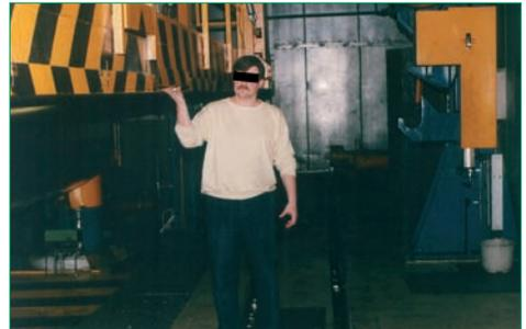
**Bild 11** Nach unten sichert eine Schaltplatte die Quetschgefahr zum Boden
