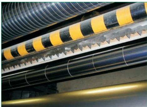
**Bild 19** Das Abschlagmesser liegt in der Parkstellung geschützt in einem Winkelprofil, so dass eine unbeabsichtigte Berührung verhindert wird.
