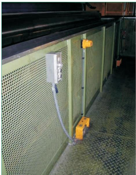
**Bild 17** An beiden Enden sowie in der Mitte der Bühne sind Stellteile zum Fahren der Bühne im Tipfbetrieb installiert. Durch ausreichend große Bügel sind sie gegen unbeabsichtigtes Betätigen gesichert. Die Bedieneinrichtung im Vordergrund dient dem Verfahren der Walzenwechselbühnen.
