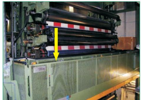
**Bild 13** Auf der Oberkante der Absturzsicherung zum Walzenstapel hin befindet sich eine Schallleiste, die bei Betätigung die Bewegung der Bühne stoppt.
