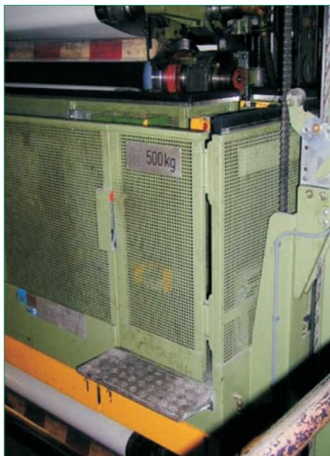
**Bild 6** Die Tragfähigkeit der Fahrbühne ist deutlich erkennbar und dauerhaft angegeben. An neuen Bühnen muss zusätzlich die höchstzulässige Personenzahl angegeben sein.
