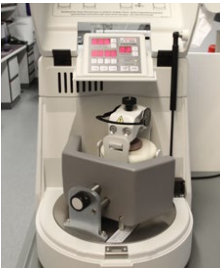
Abb. 10 Pulvermühle mit geschlossenem Mahlbecher
