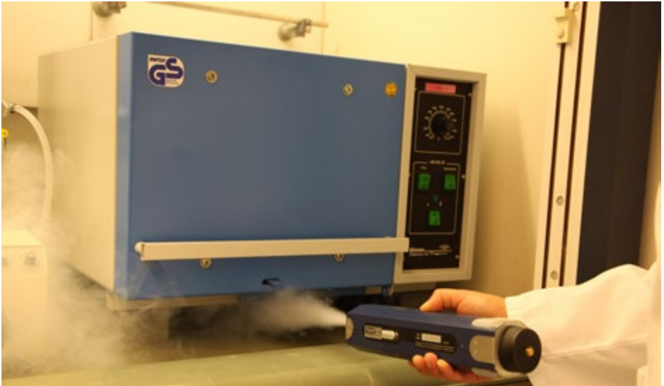
Abb. 4 Handgehaltener Nebelgenerator mit Akku
