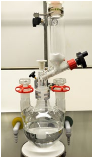
Abb. 8 Handbetätigter Pulverdosiertrichter auf einem Dreihalskolben
