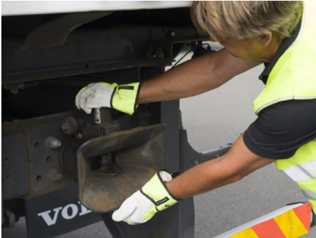
Abb. 36 Prüfen auf Längs- und Höhen-/ Radialspiel
