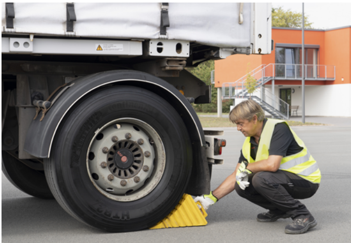
Abb. 11 Anlegen der Unterleg- keile
