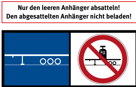
Abb. 26 Kennzeichnung an Sattelstützen geringerer Tragfähigkeit
