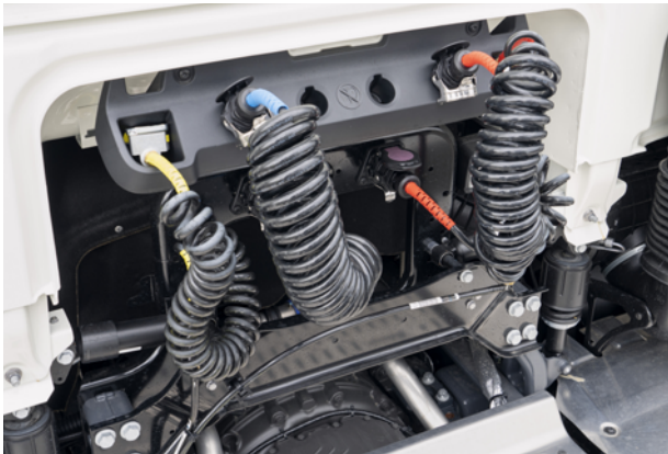
Abb. 30 Unterbringung der Leitungen
