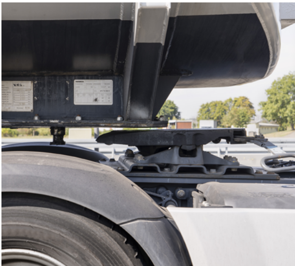
Abb. 22 Luftspalt (max. 5 cm) zwischen Sattelplatte und Aufgleitplatte
