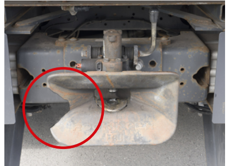
Abb. 37 Fangmaul auf Arretierung und Schäden kontrollieren
