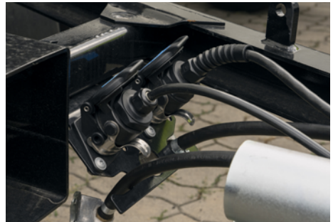
Abb. 20 Verbindungsleitungen in Parkdose stecken
