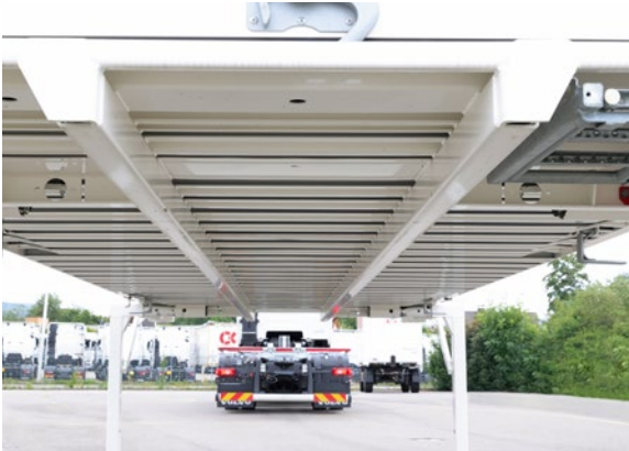
Abb. 24 Führungstunnel des Wechselbehälters
