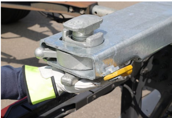
Abb. 26 Spannmutter anheben und Drehzapfen drehen
