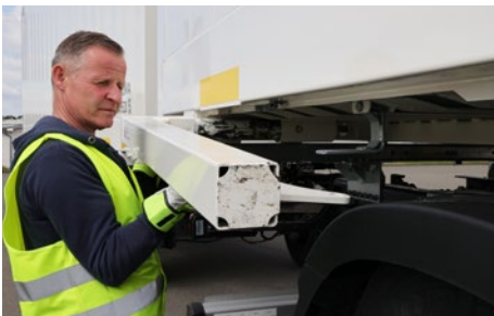
Abb. 8 Stützbein mit Stützbeinstrebe mit beiden Händen herausziehen
