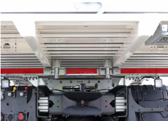
Abb. 25 Führungsrollen laufen bestimmungsgemäß im Führungstunnel
