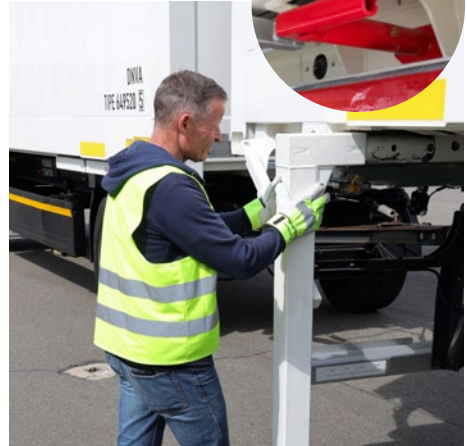
Abb. 13 Stützbeinverriegelung einrasten lassen und Verriegelung kontrollieren
