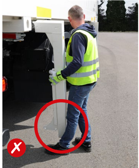
Abb. 11 Achtung: Verletzungsgefahr im Schwenkbereich!
