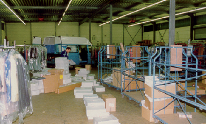
Bild 10 Manuelle Sortierung in freien Hallenbereichen
