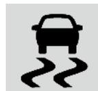
ESP ist eine so genannte Fahrdynamikregelung. ESP wirkt Schleuderbewegungen entgegen durch Eingriffe der Elektronik in die Bremsanlage (je nach Erfor-
