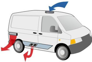
Prinzip der Druckbelüftung für schwere Gase
