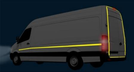
Sehen und gesehen werden – für die Verkehrssicherheit hat das die oberste Priorität. Die Konturmarkierungen sind meistens am Heck, seltener an den Längsseiten angebracht. Die aufgeklebten Streifen bestehen aus retroreflektierendem Material, das darauf fallendes Licht reflektiert, also quasi selbst leuchtet.
