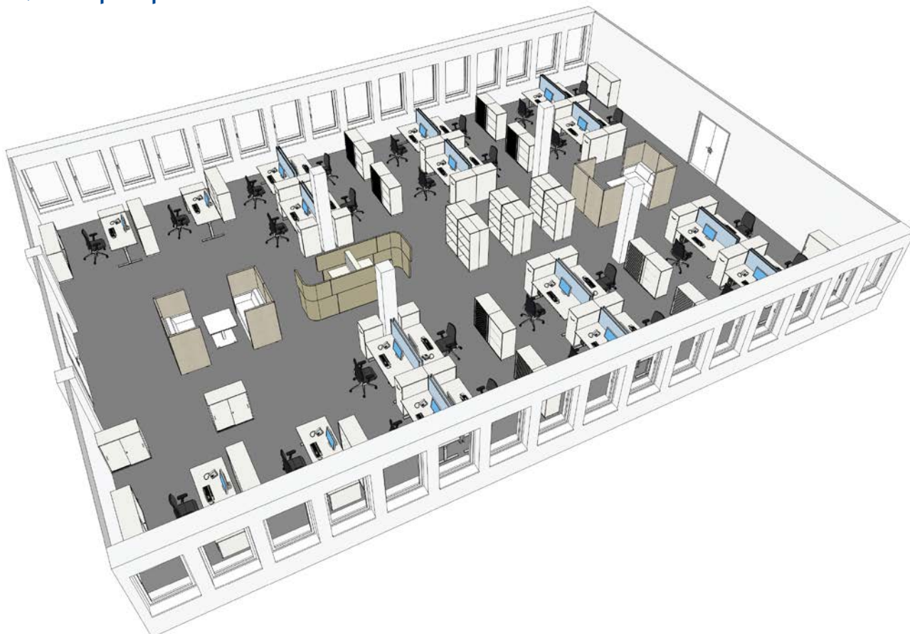
Abb. 48 3D-Ansicht Open Space Office mit 28 Arbeitsplätzen
