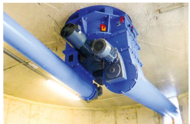
Abb. 7.12 Austrageinrichtung mit 2 gleichzeitig oder alternativ zu nutzenden Entnahmestutzen
