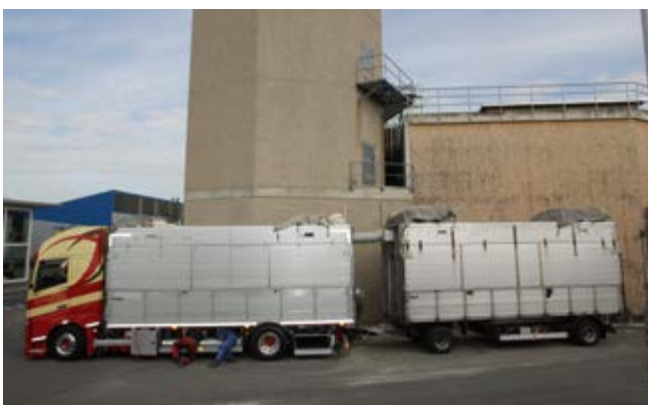
Abb. 7.9 LKW mit eigener Absauganlage
