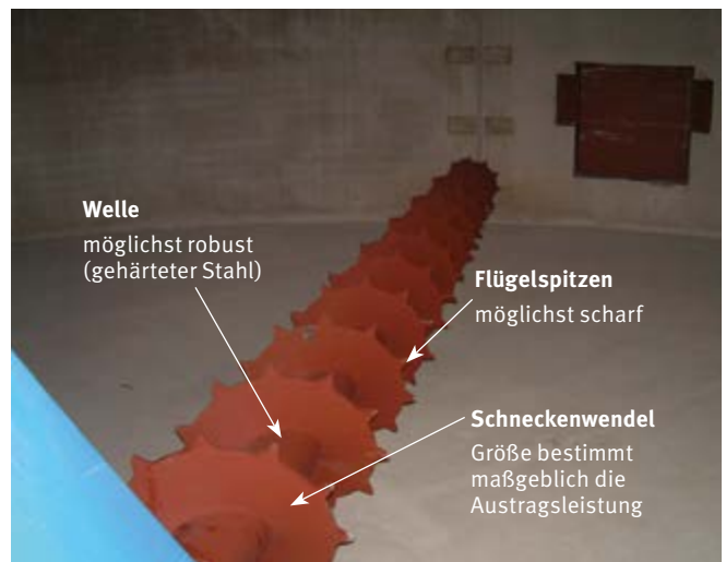
Abb. 6.10 Konstruktionsmerkmale einer Austragschnecke
