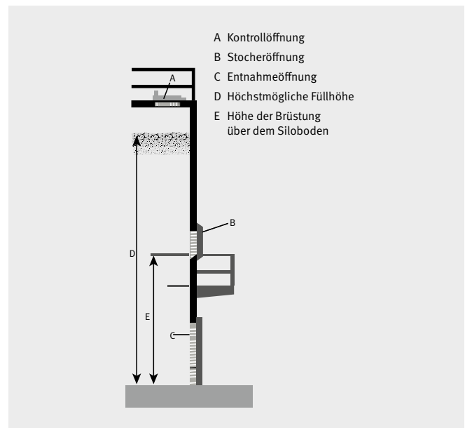
Abb. 5.4 Korrekte Anordnung der Entnahme- und Stocheröffnungen
