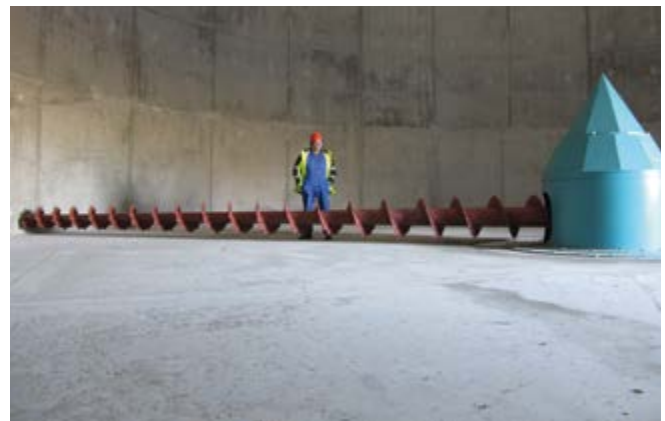
Abb. 6.9 Horizontale Austragsschnecke im Bodenbereich
