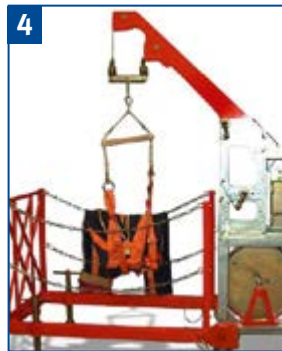
Einfahren mit Siloeinfahrvorrichtung.
