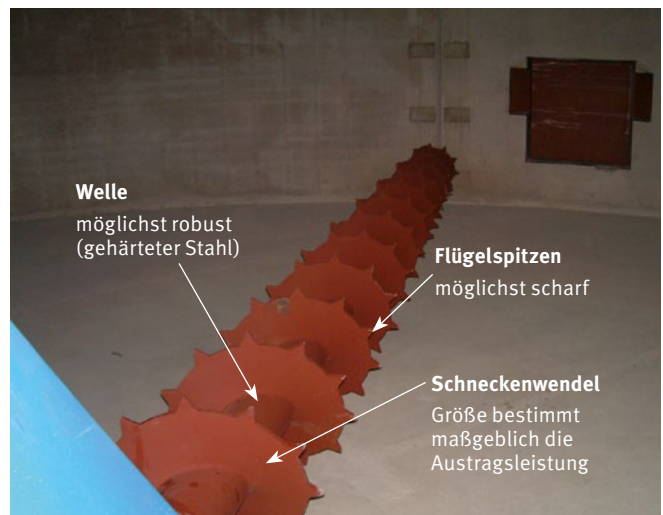
Abb. 6.10 Konstruktionsmerkmale einer Austragschnecke
