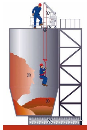
Abb. 7.14 Prinzip-Skizze zum Befahren eines Silos
