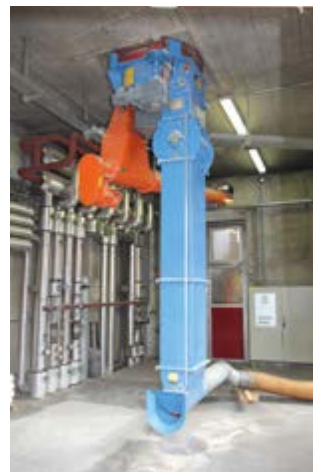
Abb. 7.10 Späneentnahme über Anschluss an gesonderten Entnahmestutzen
