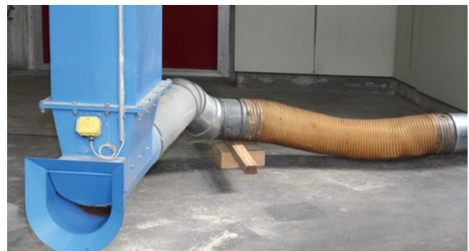
Abb. 7.6 und 7.7 Austrageeinrichtung mit 2 Ausfallstützen zum wahlweisen Späne-Transport in eine Heizungsanlage (7.6 oben) oder eine externe Transportanlage/Späne-Entsorgung (7.7 unten)
