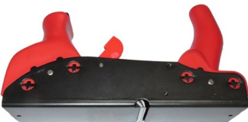
Abb. 57 Handhobel aus Metall und Kunststoff
