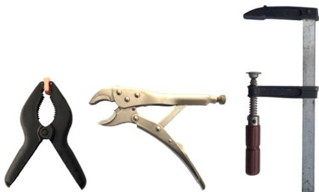
Abb. 59 links Handklemme, Mitte Gripzange, rechts Schraubzwinde
