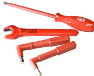
Abb. 66 Beispiele für vollisoliertes Werkzeug
