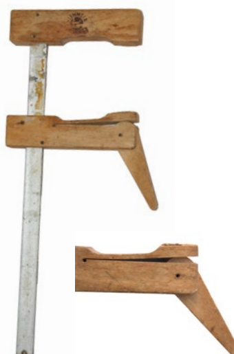
Abb. 61 Holzzwinde, rechts Zunge mit Excenterhebel
