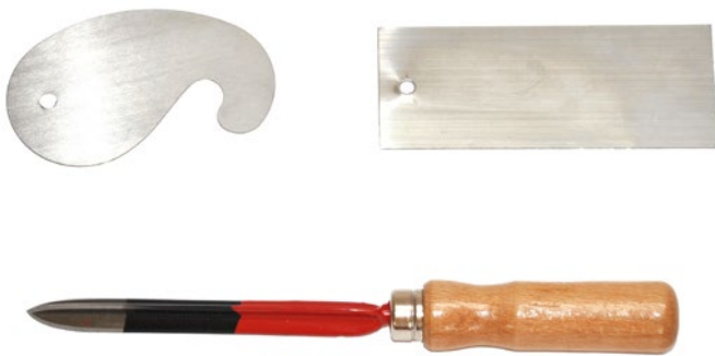
Abb. 65 Ziehklingen (oben) und Dreikant Hohlschaber (unten)
