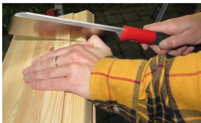
Abb. 47 Führen eines Sägeblatts beim Anschnitt
