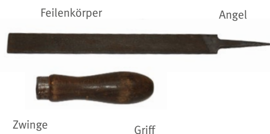
Abb. 48 Bezeichnungen an der Feile
