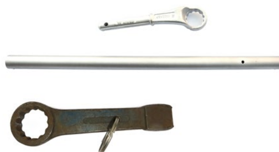
Abb. 29 oben: Zugringschlüssel mit Aufsteckrohr, unten: Schlag-Ringschlüssel
