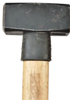
Abb. 14 Stielschutz an einem Fäustel
