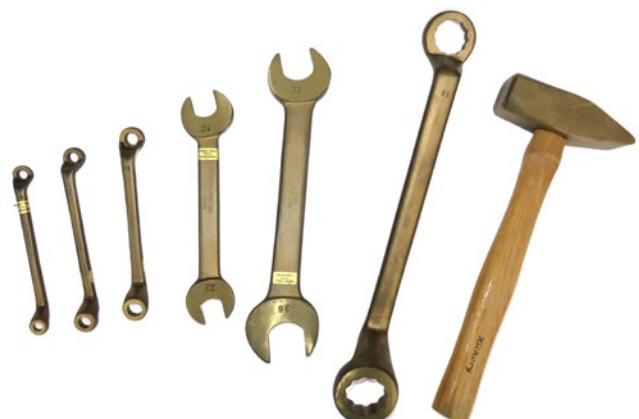
Abb. 69 Beispiele für funkenarme Werkzeuge
