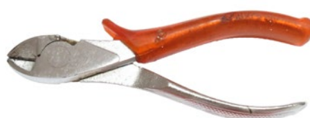
Abb. 39 Seitenschneider einsatzfähig: von weichem Draht bis Federstahl
