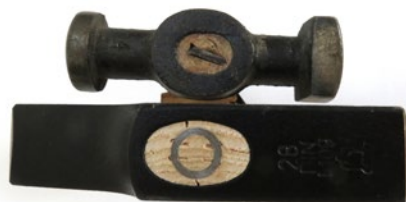
Abb. 18 Keile aus Metall befestigen den Stiel im Auge des Hammerkopfs
