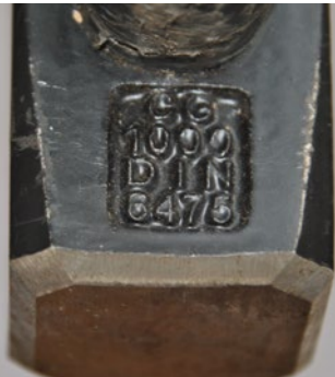
Abb. 1 Eingeprägte Norm an einem Fäustel 1
