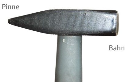
Abb. 12 Bezeichnungen am Hammerkopf
