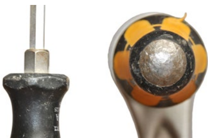
Abb. 26 links: Sechskant an der Klinge des Schraubendrehers; rechts: Schlagkopf am Griffende
