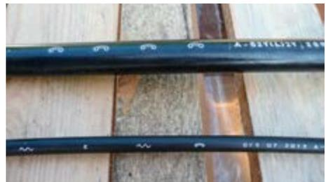
Abb. 8 Kupferkabel (oben) und Glasfaserkabel
