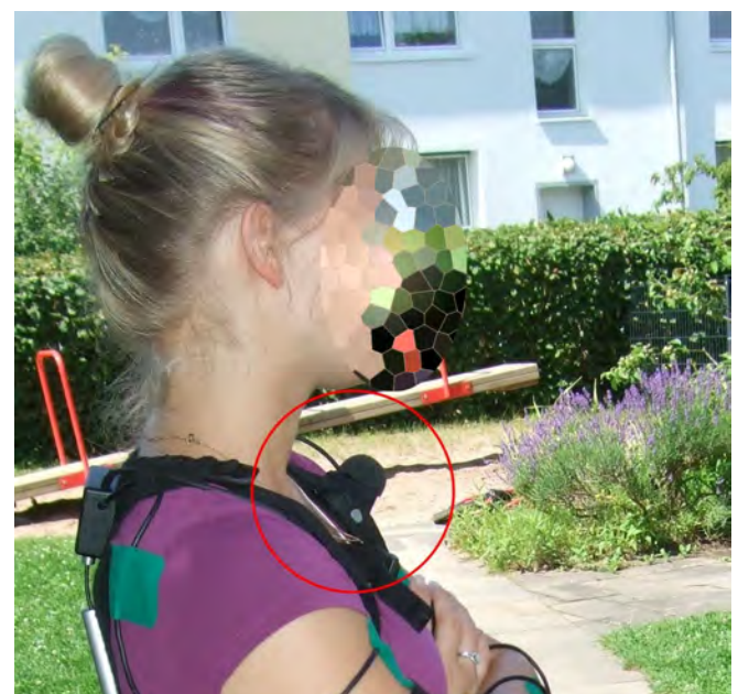
Abbildung 8: Anbringung des Lärmdosimeters am Brustgurt des CUELA-Systems
