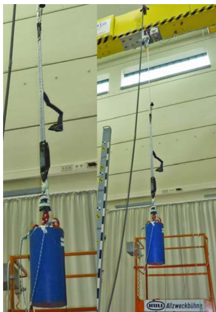
Aufreißfalldämpfer mit integriertem Verbindungsmittel nach Abbremsvorgang
