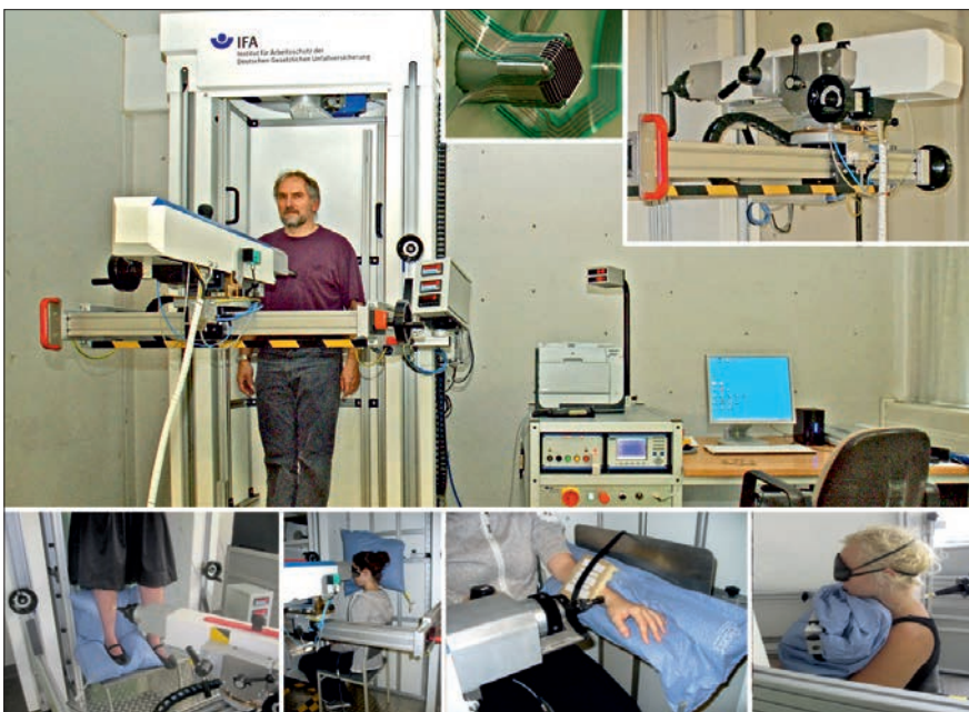
Druckalgometer (Gesamte Einrichtung, gesteuerter Applikator, Stößel mit Druckmessfolie, Fixierung von Messlokalisierungen)
