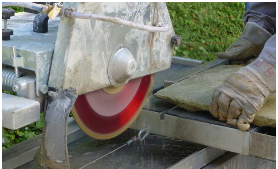
Untersuchung von lärmarmen Trennscheiben auf einer Steinsäge
