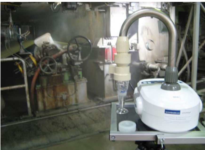
Bakterienprobenahme aus der Luft im Arbeitsbereich der Papierherstellung mit Coriolis®µ, Fa. Bertin, Frankreich
