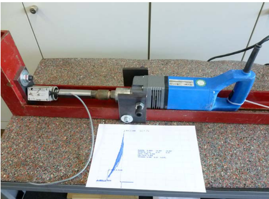
Versuchsaufbau – Bestimmung des Reaktionsmoments an einer Bohrmaschine
