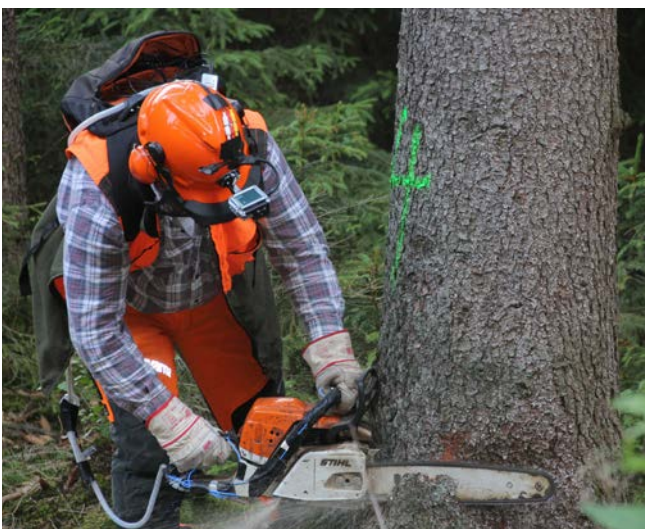
Messung der Hand-Arm-Vibration einer Motorkettensäge unter realen Einsatzbedingungen
