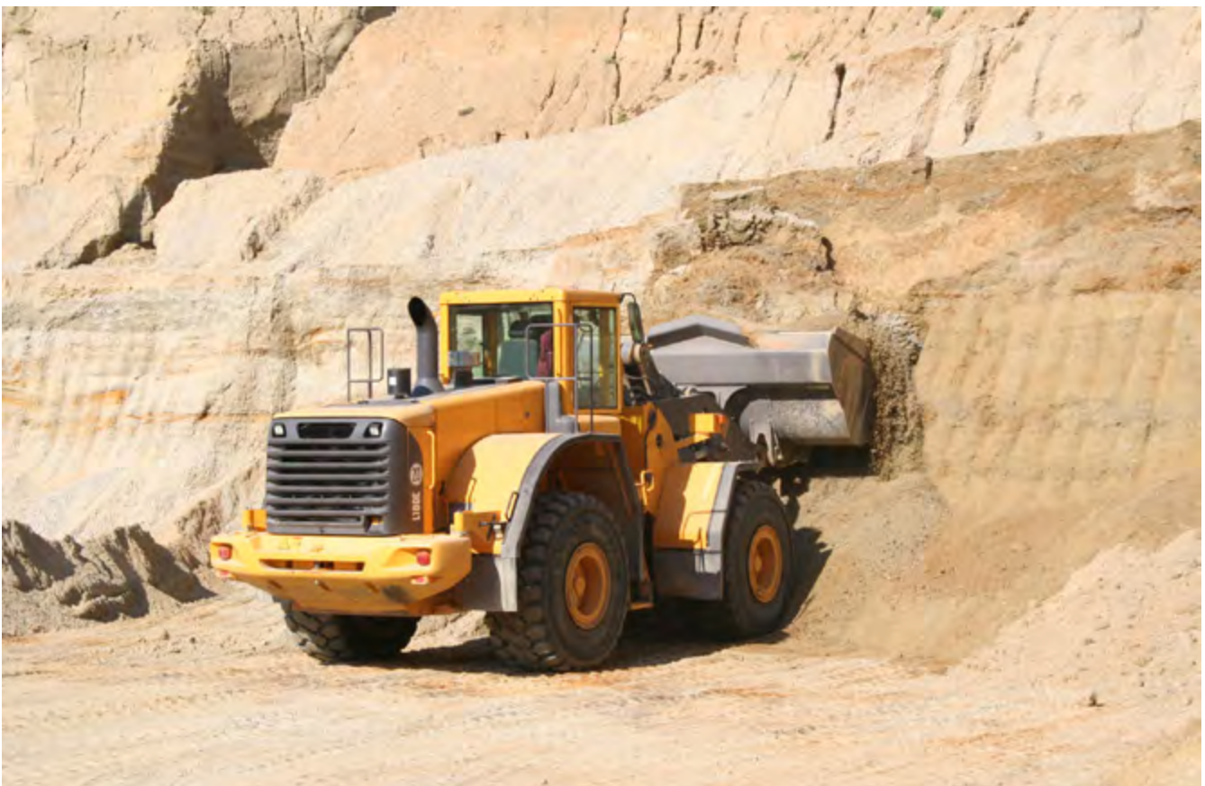
Abb. 1 Sandgewinnung mit dem Radlader und regelgerechter Wandhöhe an der Gewinnungsstelle
