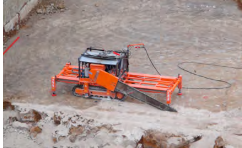
Abb. 1 Gewinnung durch Schrämmen
