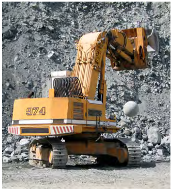
Abb. 3 Nachzerkleinern von Knäppern mit einer Stahlkugel
