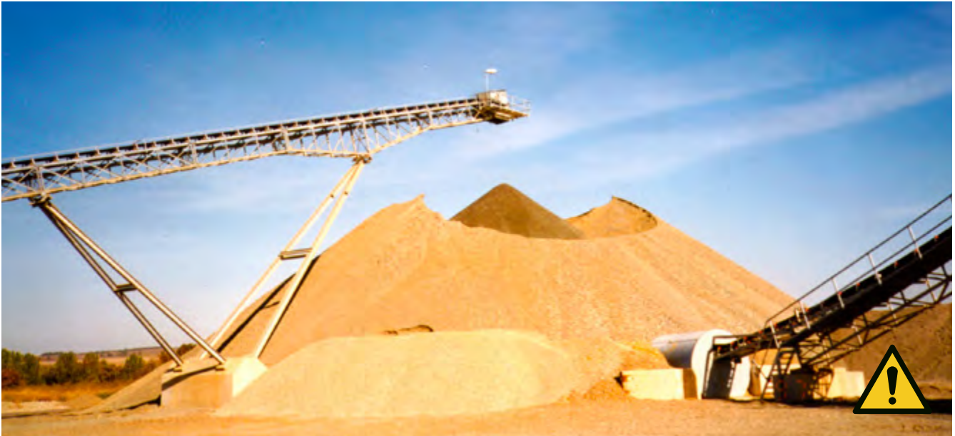
Abb. 1 Unterflurabzug mit Einsinkgefahr im Abzugstrichter
