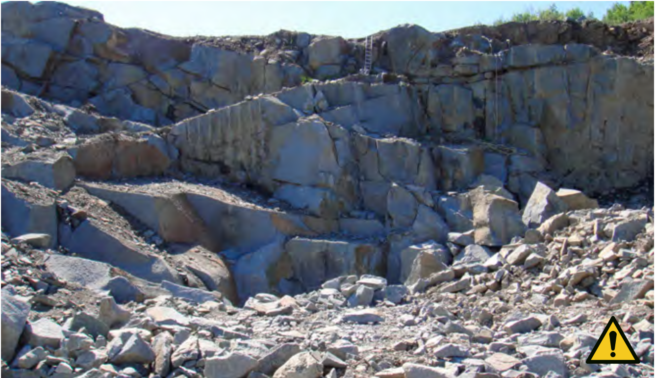
Abb. 1 Unregelmäßiger Wandaufbau im Werksteinbruch
