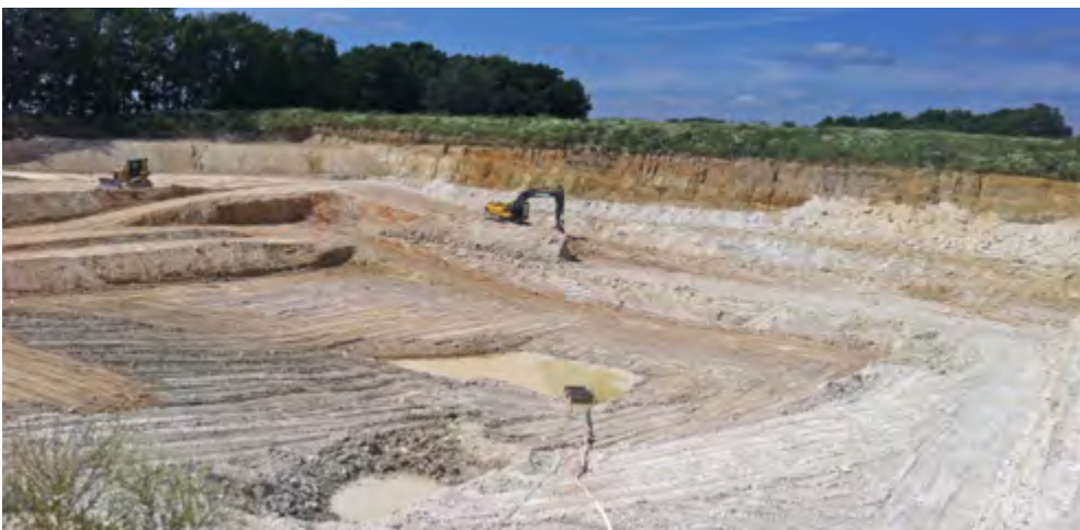
Abb. 2 Lagenweise Gewinnung in Tongrube
