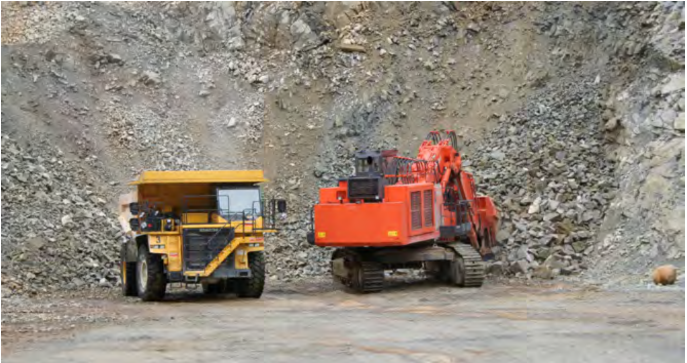
Abb. 1 Verladen von Haufwerk mit Hochlöffelbagger
