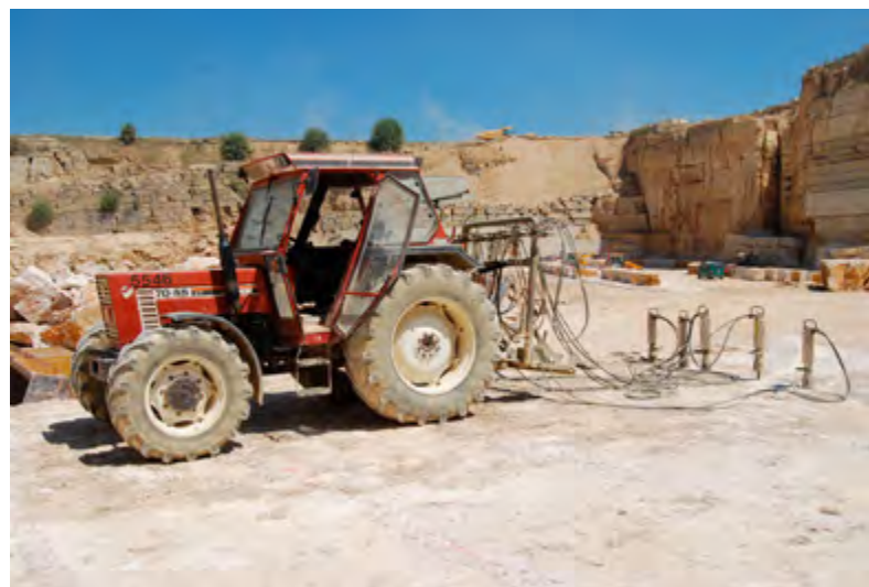
Abb. 3 Abdrücken von Rohblöcken mit Hydraulikclanzen
