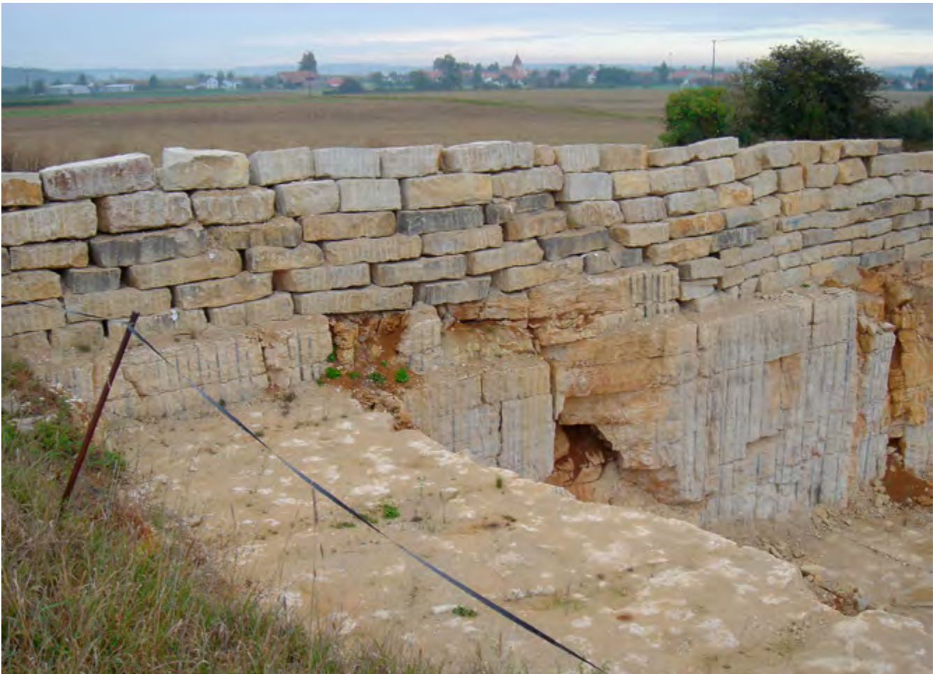
Abb. 1 Abraum ausreichend beseitigt – Schutzstreifen ausreichend
