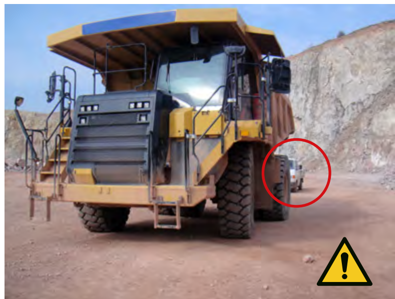
Abb. 2 SKW mit sicherem Zugang zum Führerhaus Achtung: Der PKW dahinter befindet sich im „toten Winkel“.
