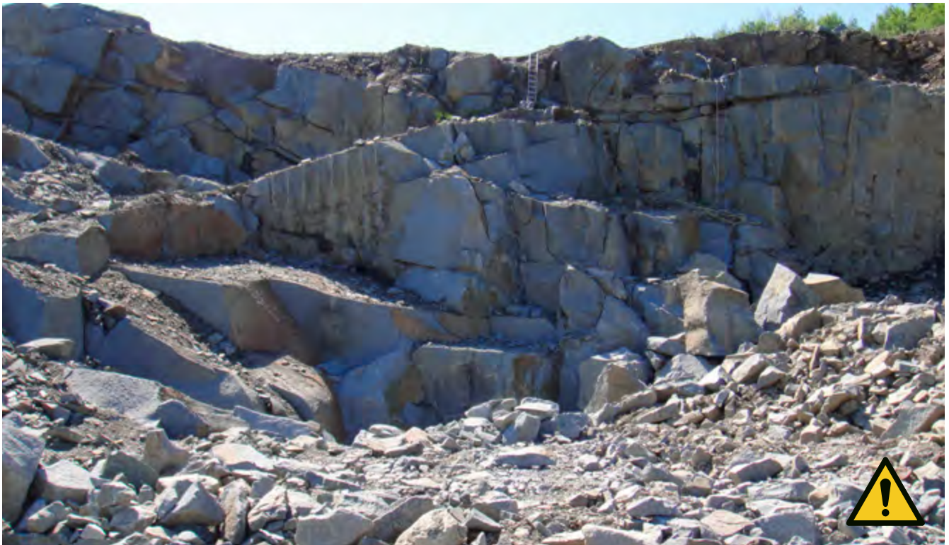
Abb. 1 Unregelmäßiger Wandaufbau im Werksteinbruch
