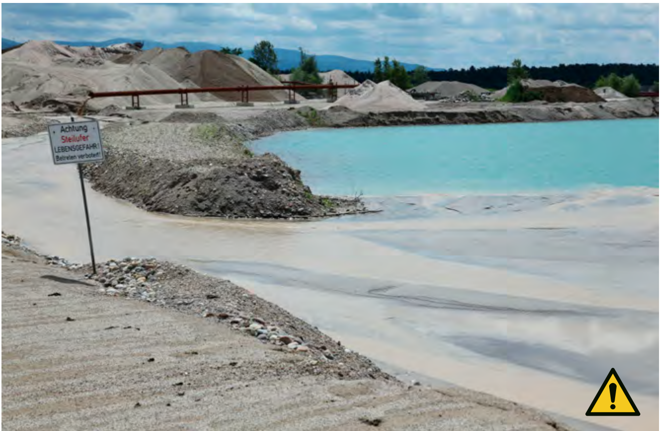
Abb. 1 Absetzteich mit der Gefahr des Einsinkens
