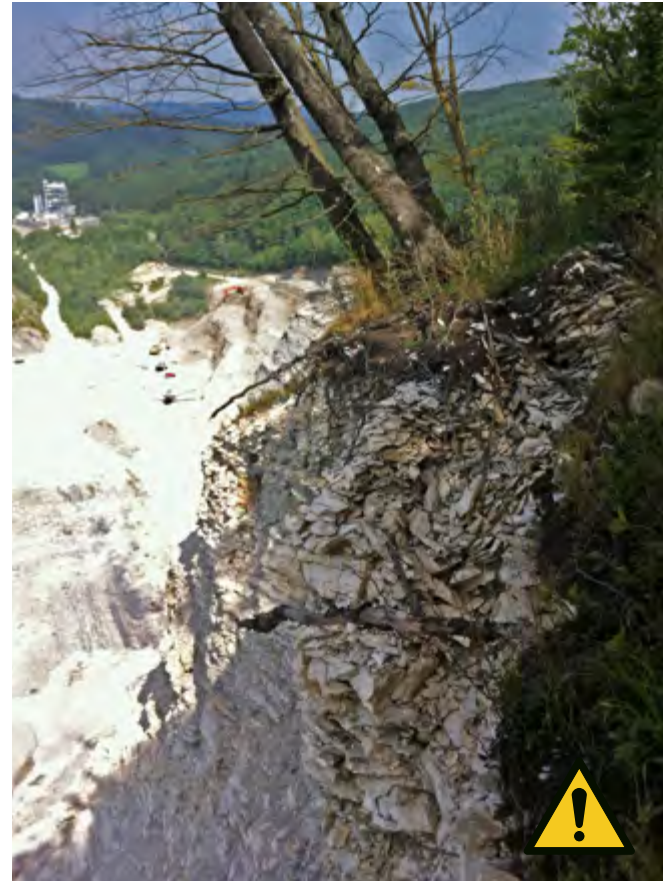
Abb. 3 Hier besteht Lebensgefahr für die Arbeitsplätze unterhalb des Abraums
