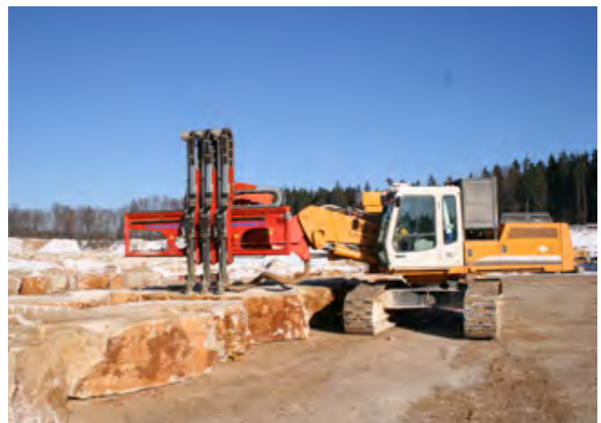
Abb. 4 Lafettenbohrmaschine in der Werksteingewinnung
