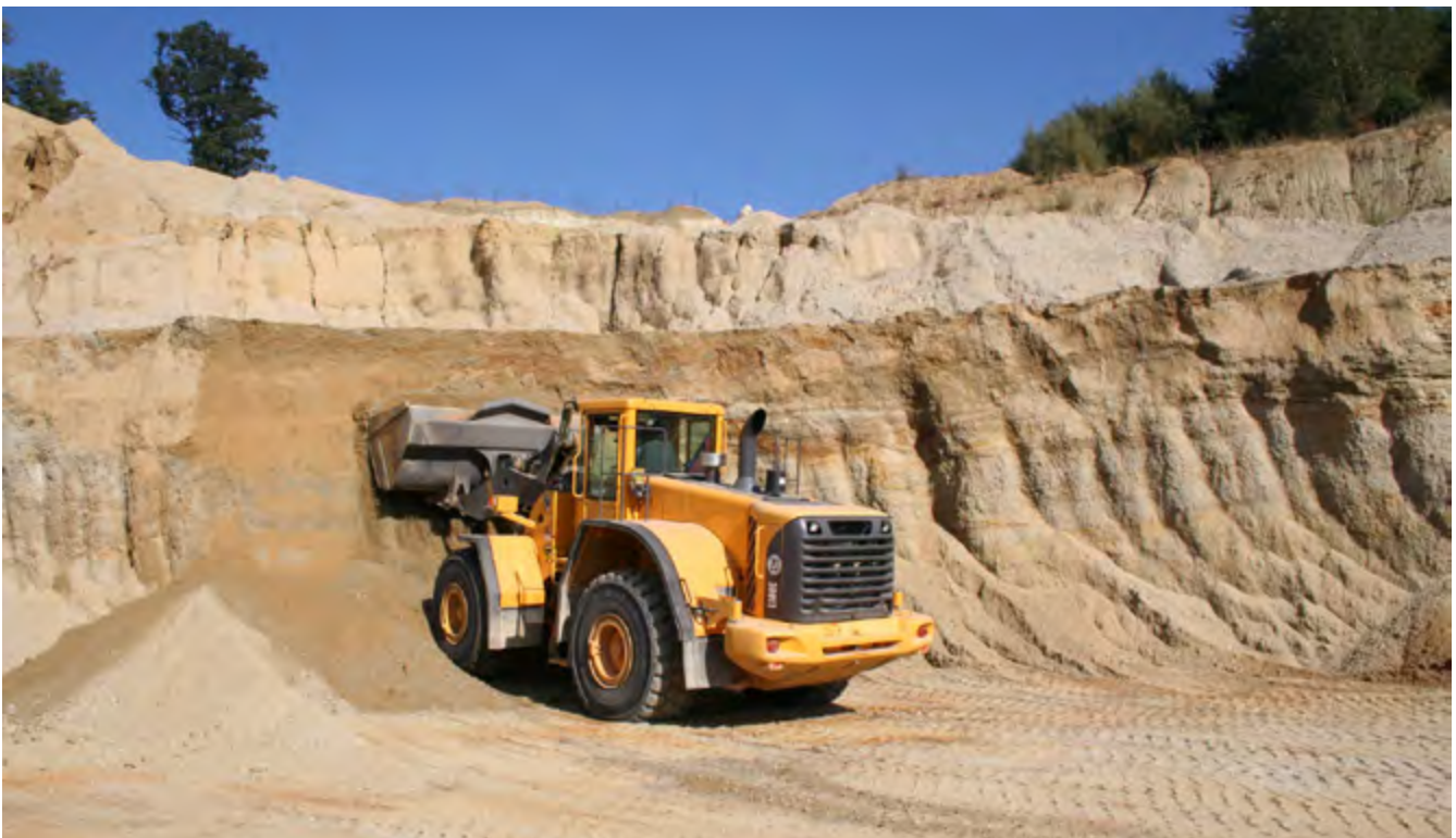
Abb. 2 Gewinnung mit dem Radlader und regelgerechter Wandhöhe
