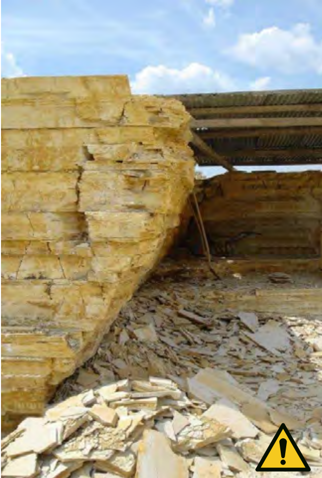
Abb. 2 Wandüberhang bei Plattenkalkgewinnung
