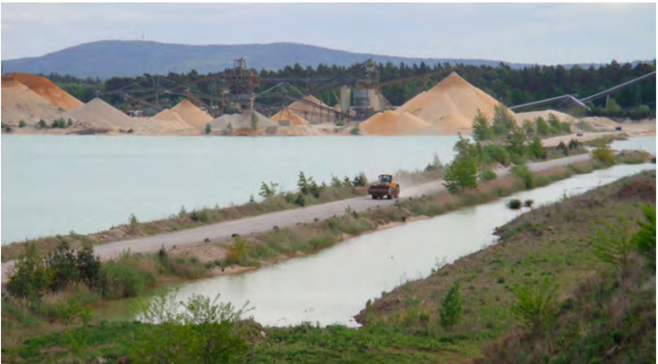
Abb. 1 Fahrstraßen müssen zu den offenen Wasserflächen hin gegen Hineinstürzen gesichert sein
