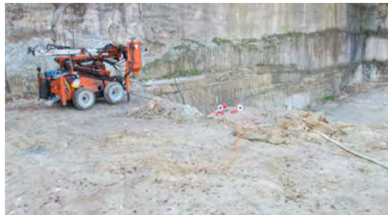
Abb. 2 Gewinnung durch Bohren und Sprengen
