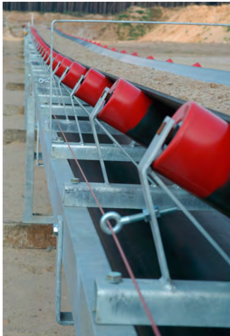
Abb. 3 Förderband mit Reißleine für den Not-Halt
