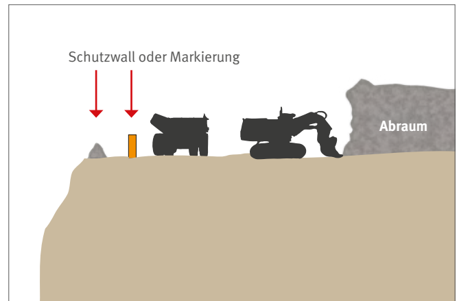
Abb. 3 Schutzstreifen bei maschineller Abräumbeseitigung im Hochschnitt
