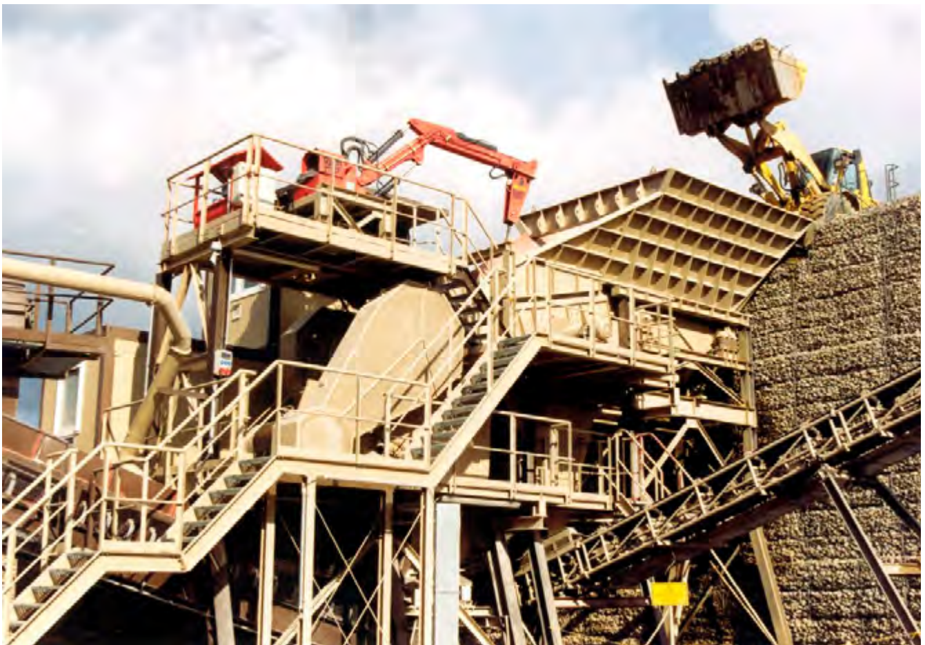
Abb. 1 Sichere Verkehrswege an der Aufbereitung und Hydraulikhammer zur Beseitigung von Verstopfungen
