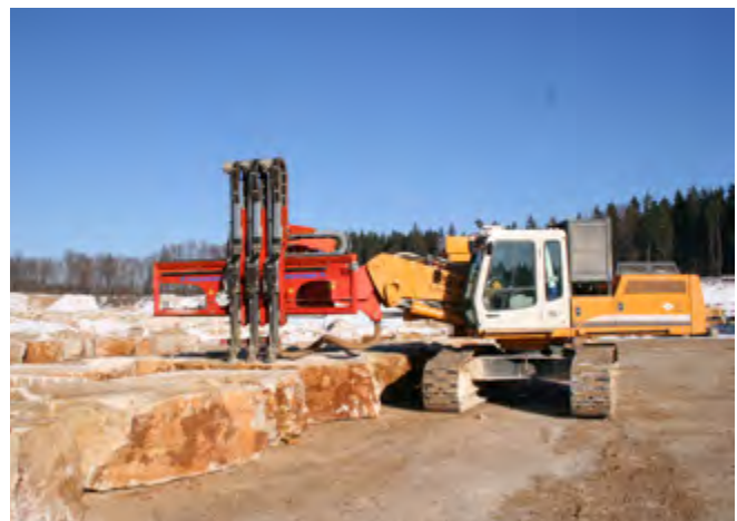
Abb. 4 Lafettenbohrmaschine in der Werksteingewinnung
