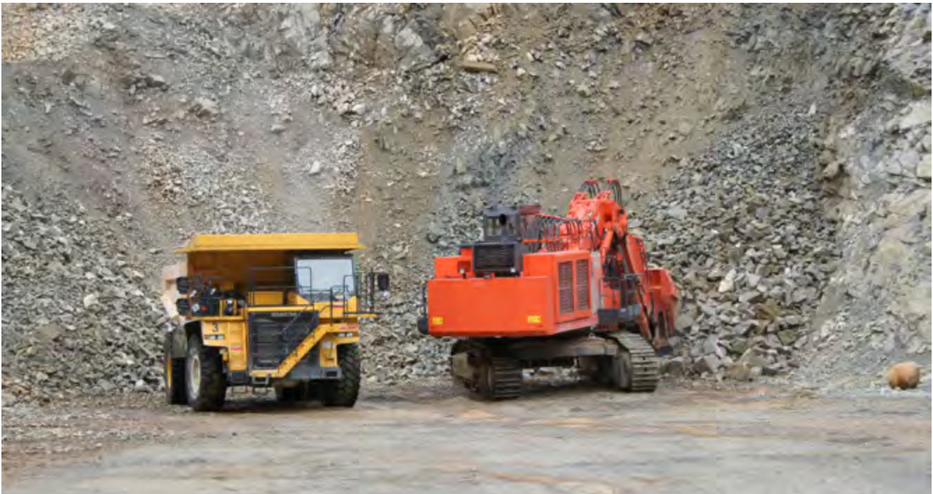
Abb. 1 Verladen von Haufwerk mit Hochlöffelbagger
