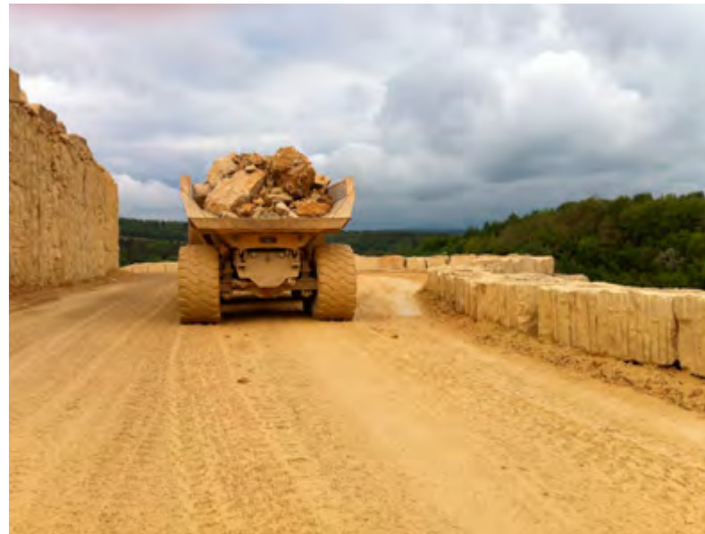
Abb. 2 Einspurige Fahrstraße im Steinbruch
