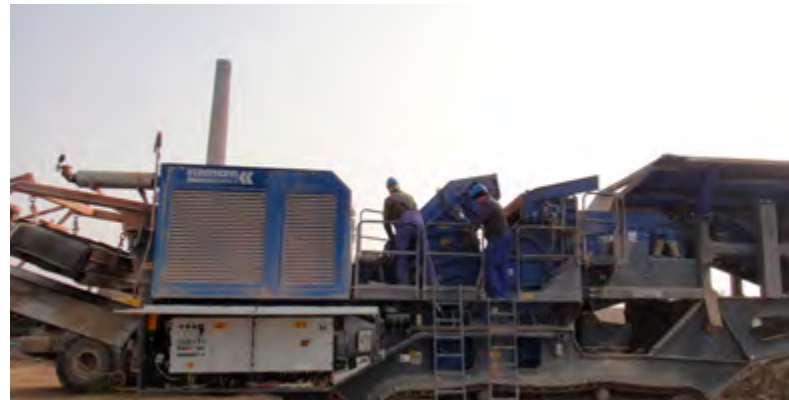
Abb. 2 Mobile Brecheranlage mit Raupenfahrwerk bei der Reparatur
