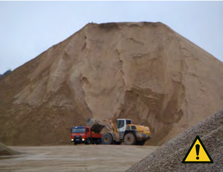
Abb. 2 Gefahr von nachrutschenden Massen an einer Halde
