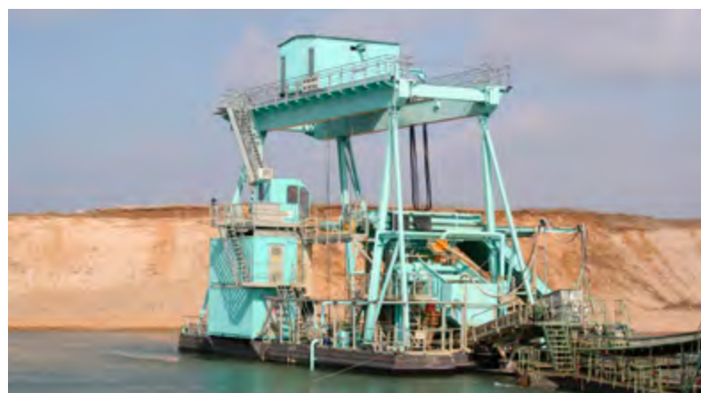
Abb. 2 Nassgewinnung mit Schwimmbagger
