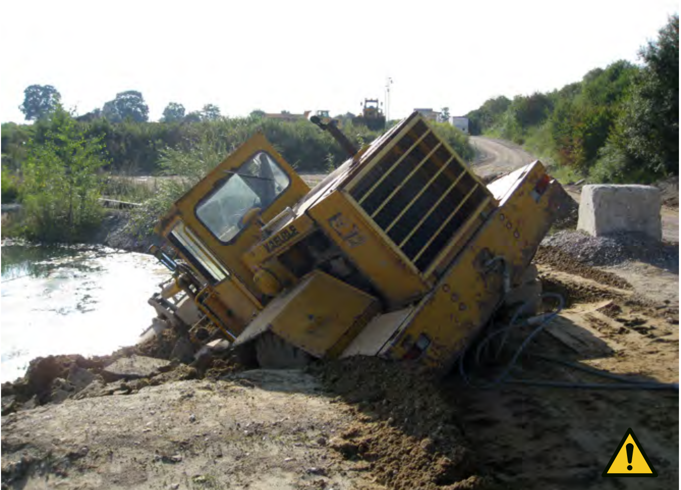
Abb. 2 Einsinken in nicht verfestigten Materialien sedimentiertem Feinstmaterial
