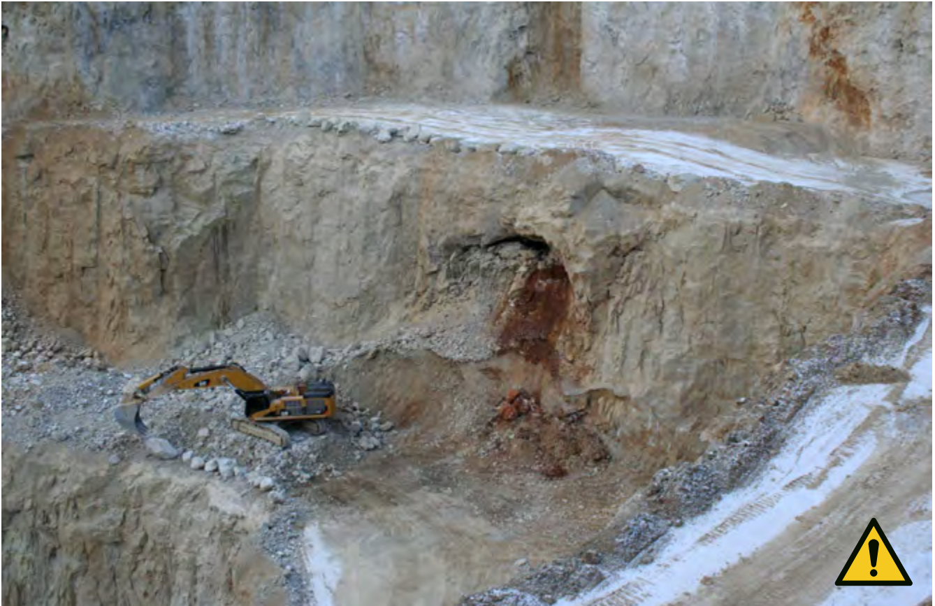
Abb. 1 Unterhöhlungen und Überhänge bedeuten Lebensgefahr
