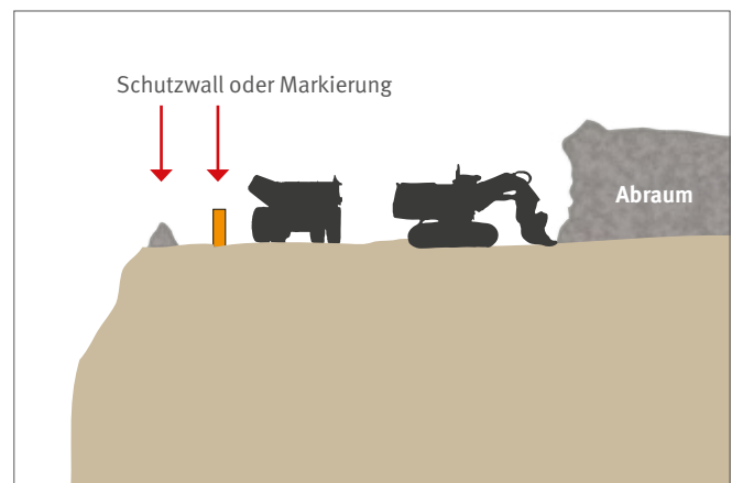
Abb. 4 Schutzstreifen bei maschineller Abräumbeseitigung im Hochschnitt
