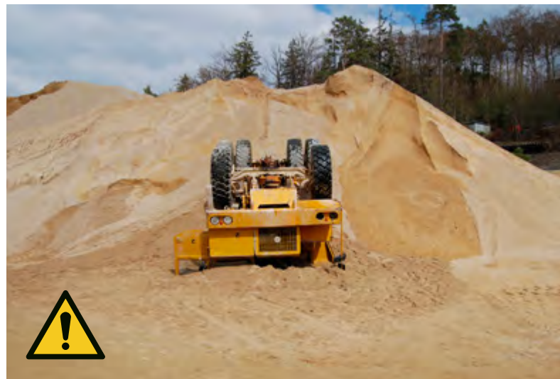
Abb. 3 Unfall bei Abkipfstelle ohne Anschlag
