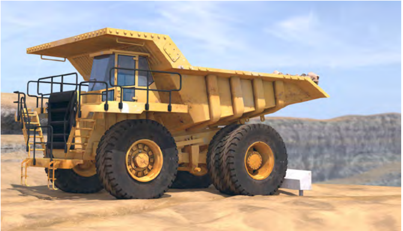
Abb. 1 Regelgerechte Ausführung einer Abkippstelle
