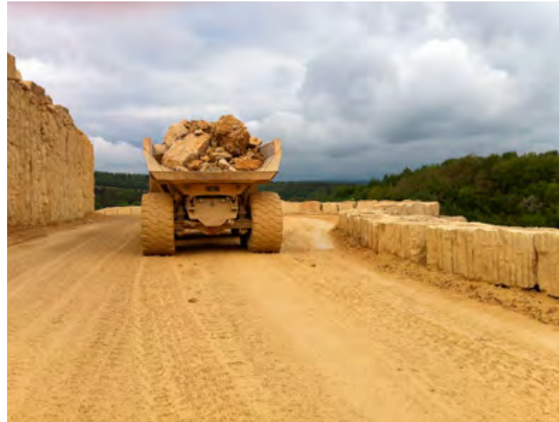
Abb. 2 Einspurige Fahrstraße im Steinbruch
