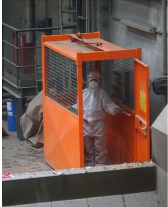
Abb.16 Rettungskorb in einem Müllbunker
