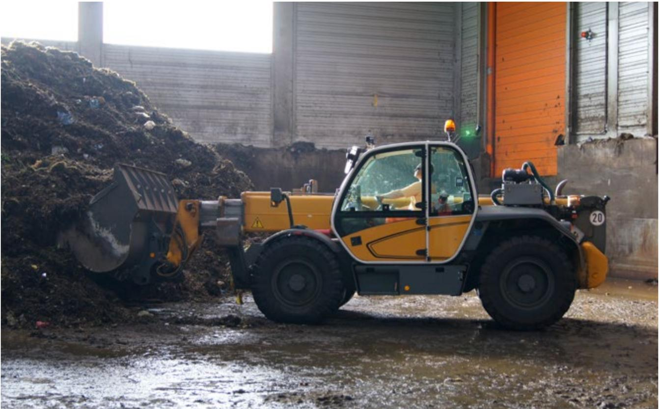
Abb. 19 Innerbetrieblicher Transport von Abfällen mit einem schutzbelüfteten Teleskop-Radlader
