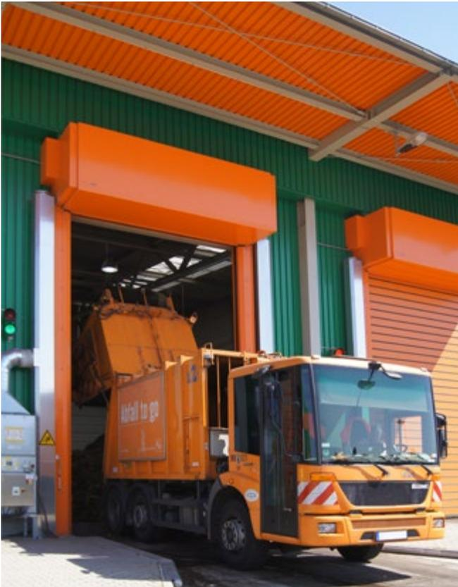
Abb. 17 Abladen (Kippen) von Bio-Abfall an gesicherter Kippstelle
