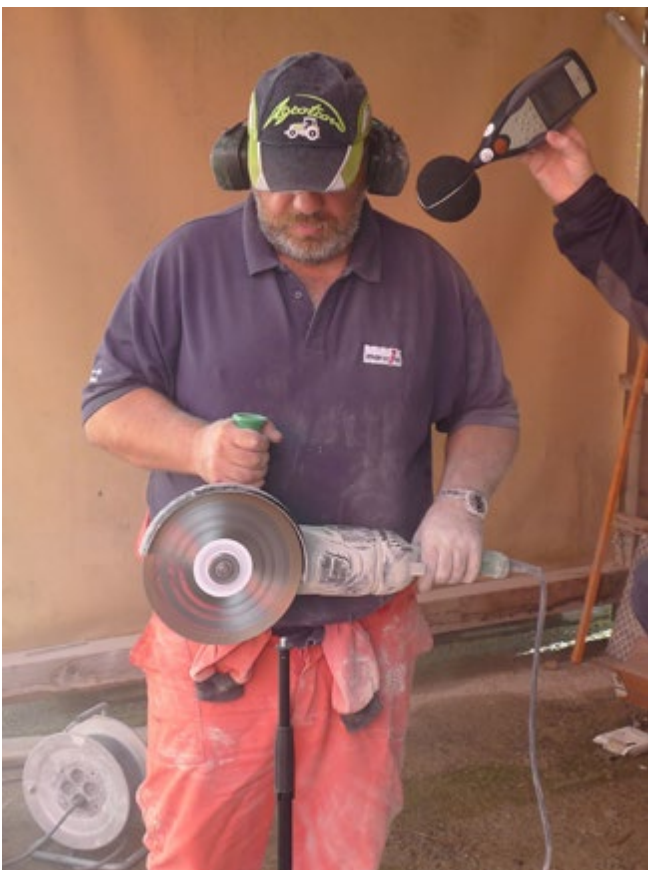
Abb. 17 Messung des Leerlaufgeräusches in ca. 0,6 m Abstand zum Mittelpunkt der Trennscheibe
