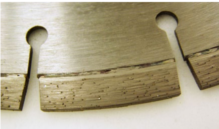
Abb. 1 Beispiel für eine Segmentierung einer Trennscheibe mit besonders lautem Leerlaufgeräusch
