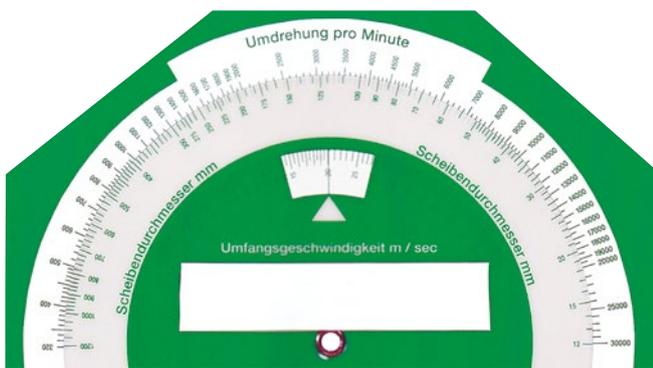
Abb. 4 Schablone Drehzahl/Umfangsgeschwindigkeit
