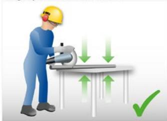
Fehlende oder falsche Einspannung des Werkstücks
