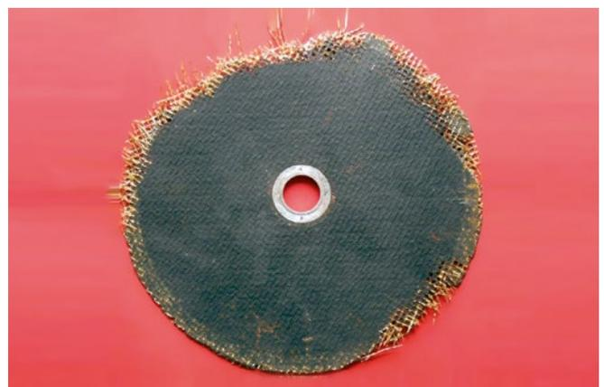
Abb. 21 Trennschleifscheibe nach Rückschlag
