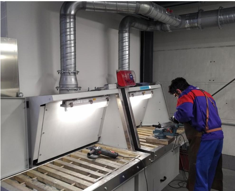
Abb. 25 Abgesaugte Schleiftische
