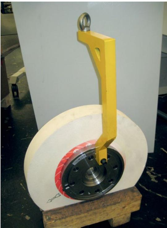
Abb. 13 Schleifscheibentransport mit Lastaufnahmemittel
