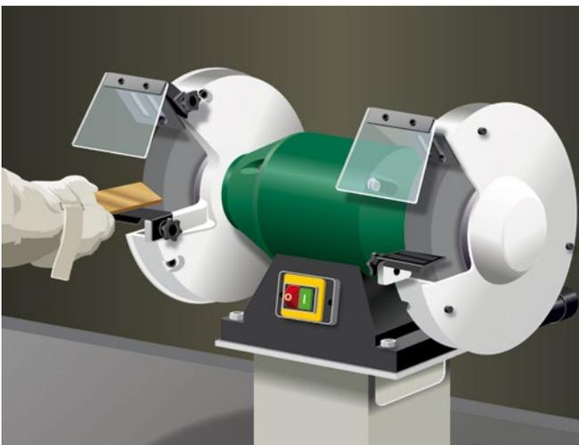
Abb. 8 Ständerschleifmaschine mit nachstellbarer Werkstückauflage und Stirnschieber
