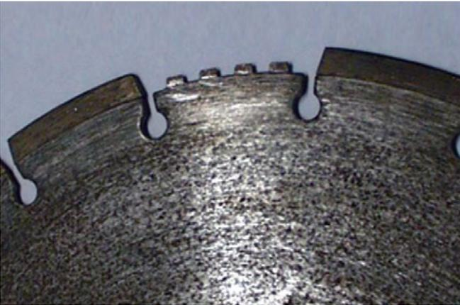
Abb. 22 Diamanttrennschleifscheibe mit abgerissemem Segment
