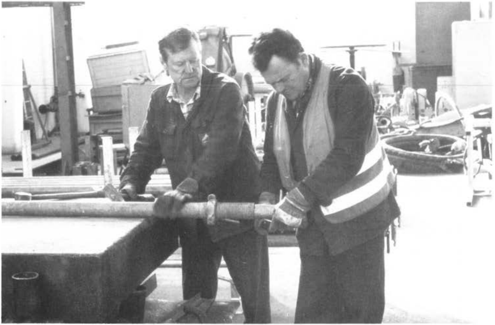
Abbildung 12: Stahlrohrstützen auf einer Stahlplatte richten (B 26)
