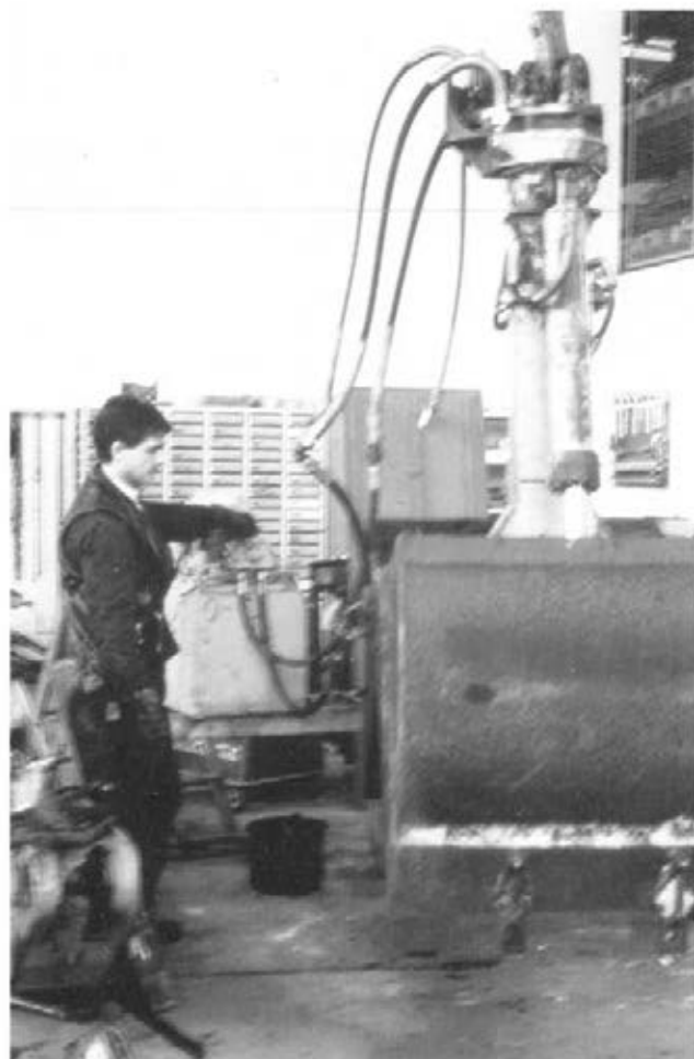
Abbildung 5: Reparierten Baggergreifer testen (B 6)
