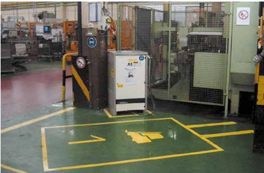
Bild 7-3: Gabelstapler nur an dem dafür vorgesehenen Platz abstellen
