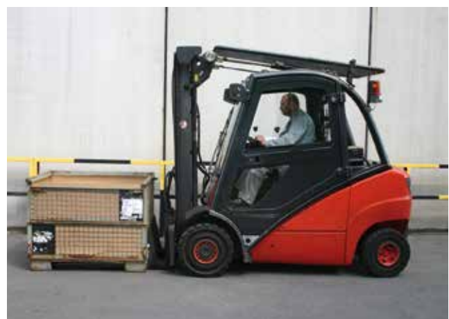
Bild 6-9: Damit der Lastschwerpunkt in der Nähe der Vorderachsen liegt, Last immer so aufnehmen, dass sie am Gabelrücken anliegt
