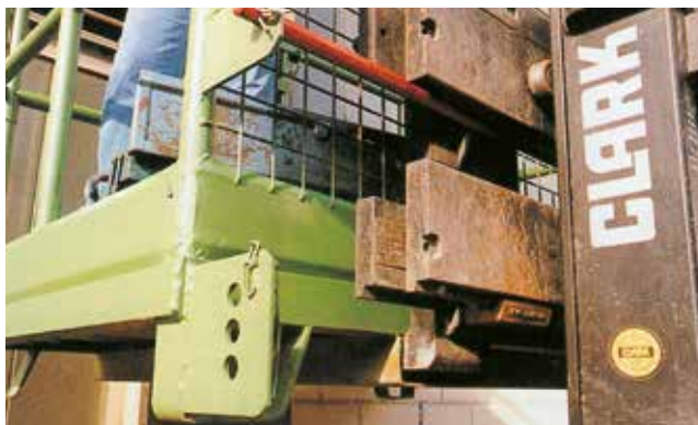
Bild 8-3: Formschlüssige Sicherung der Arbeitsbühne gegen Abkippen und Abrutschen
