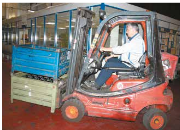
Bild 6-14: Nach hinten geneigter Hubmast
