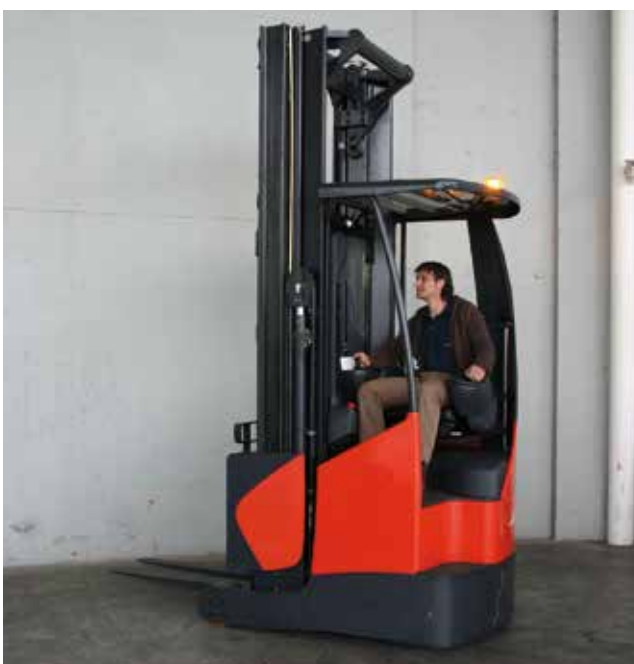
Bild 6-16: Für regelmäßiges Rückwärtsfahren geeigneter Quersitzstapler
