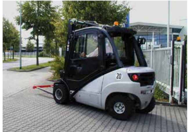
Bild 8-8: Gabelstapler mit Sonderausstattung für den Einsatz auf öffentlichen Straßen
