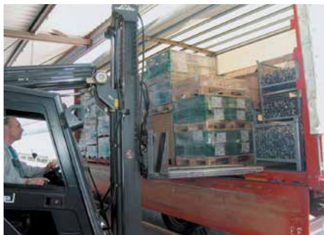
Bild 8-5: Beim Be- und Entladen von Fahrzeugen sind diese immer gegen Wegrollen zu sichern. Das heißt, der Gang ist einzulegen, die Feststellbremse anzuziehen und der Unterlegkeil unterzulegen
