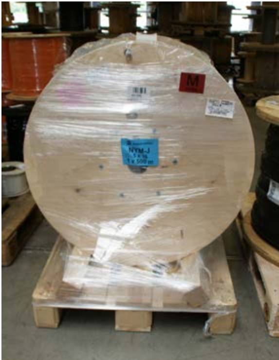
Abb. 27 Kanthölzer zur Sicherung gegen Abrollen
