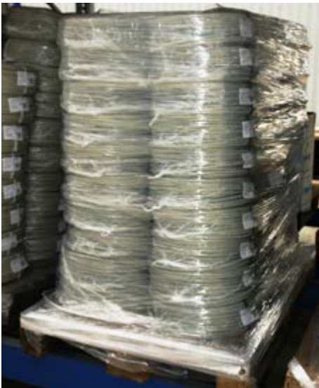
Abb. 16 Sicherung von Säulen aus Kabelrollen durch Stretchen
