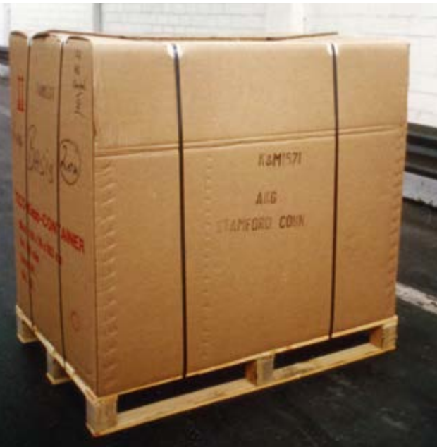
Abb. 7 Sicherung einer einstückigen Ladeeinheit durch vertikale Stahlbänder
