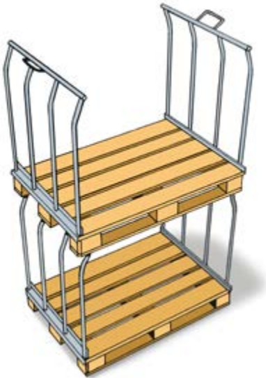
Abb. 22 Stapelrahmen zum Stapeln von Paletten mit Gütern, die keine belastbare Oberseite haben
