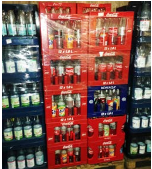
Abb. 15 Sicherung bei Säulen durch horizontalen Formschluss der Kästen und horizontale Sicherung der oberen Lagen mit Stretchfolie.
