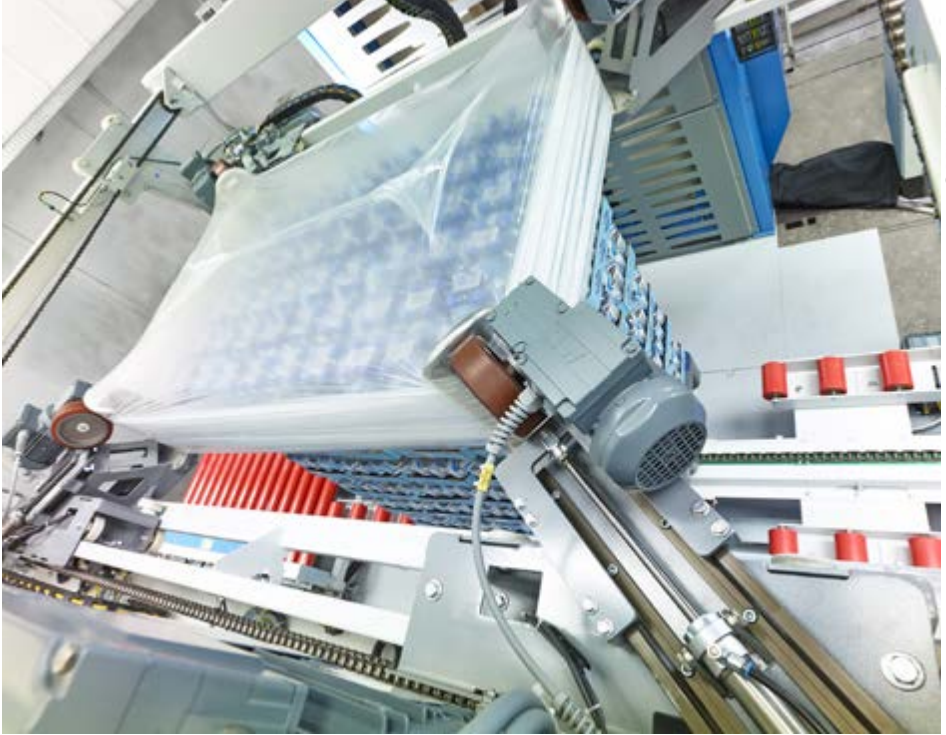
Abb. 5 Anlage zum Überziehen von Stretchhauben
