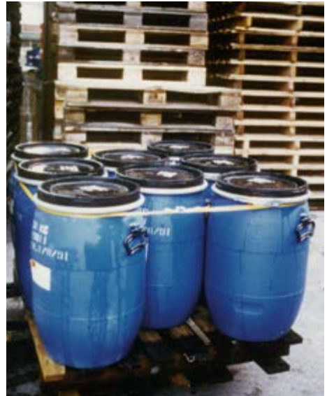
Abb. 13 Sicherung von Fässern durch Textilgurt mit Spannschloss
