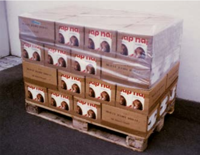
Abb. 9 Sicherung der oberen Lagen durch Kurzschrumpfhaube
