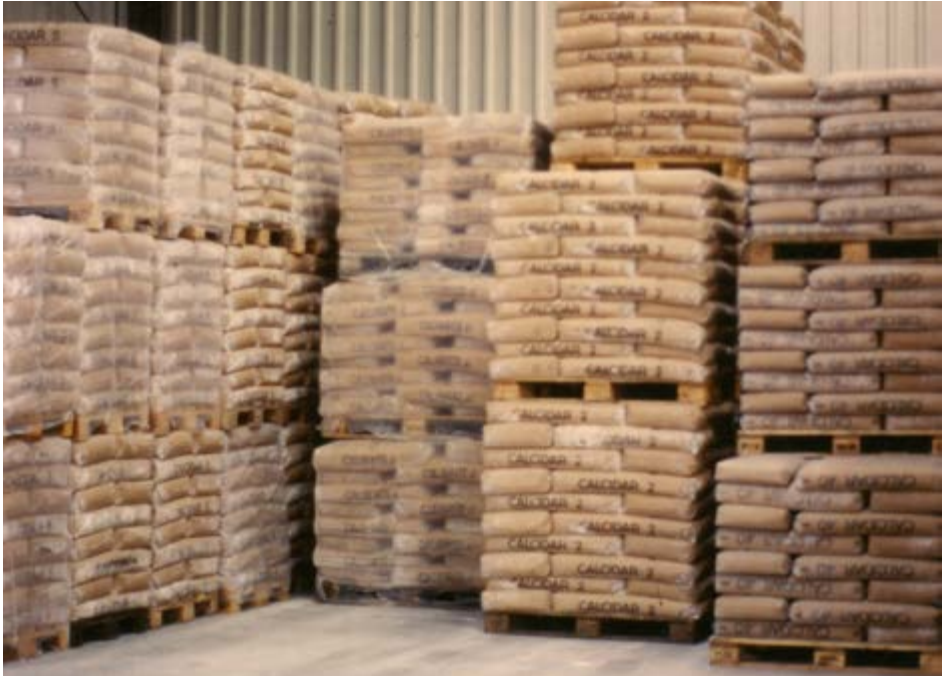
Abb. 10 Im Verbund auf Flachpaletten gestapelte Säcke: Die Ladeeinheiten sind zusätzlich durch Schrumpfhäuben gesichert.
