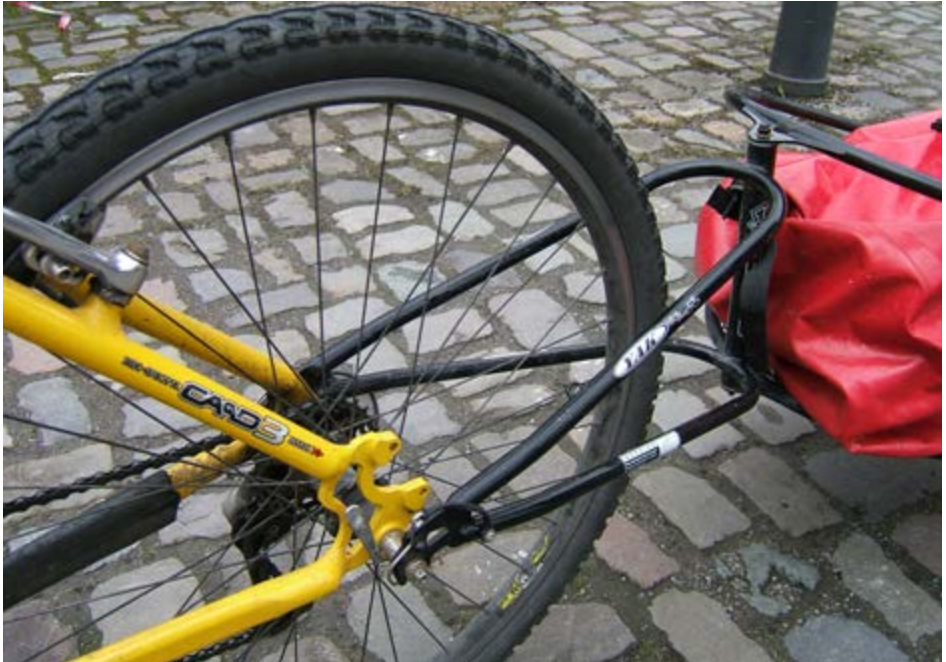
Abb. 14 Befestigung des Hängers mit Sicherung an der Steckachse
