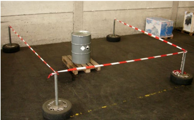
Abb. 7 Absperrung des Gefahrenbereiches um ein beschädigtes Gebinde
