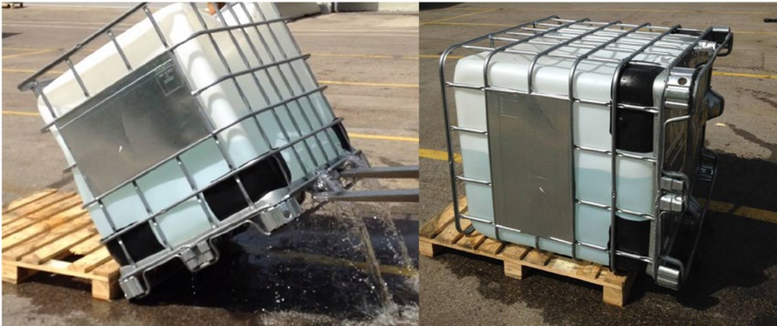
Abb. 8 Umlegen eines beschädigten IBC
