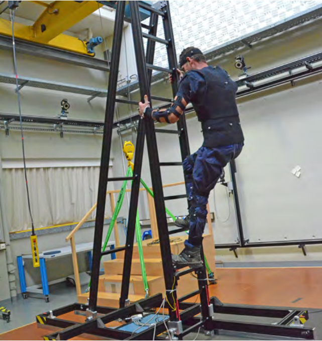
Labormessung der Hüftbelastung beim Leiternsteigen
