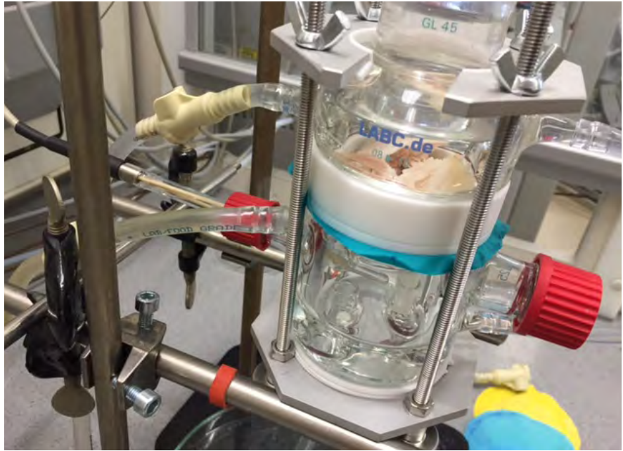
Permeationsmessung mit formaldehydhaltiger Fleischprobe auf Chemikalienschutzhandschuh
