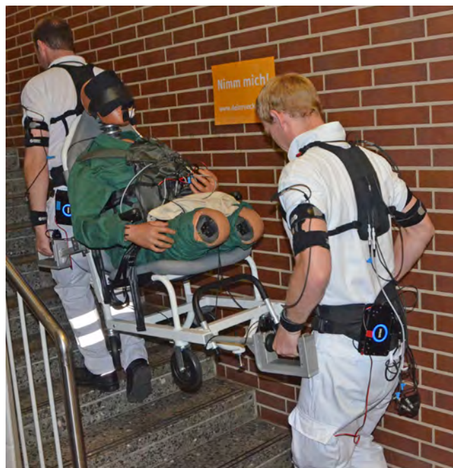
Messung der Rückenbelastung beim Personentransport (Dummy) im Treppenhaus
