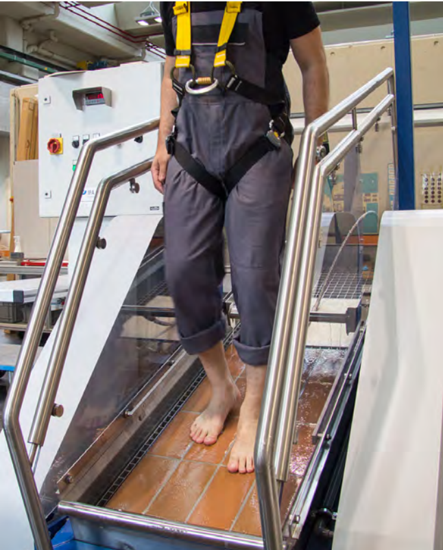
Ermittlung der Rutschhemmung durch Begehungsversuche auf der schiefen Ebene
