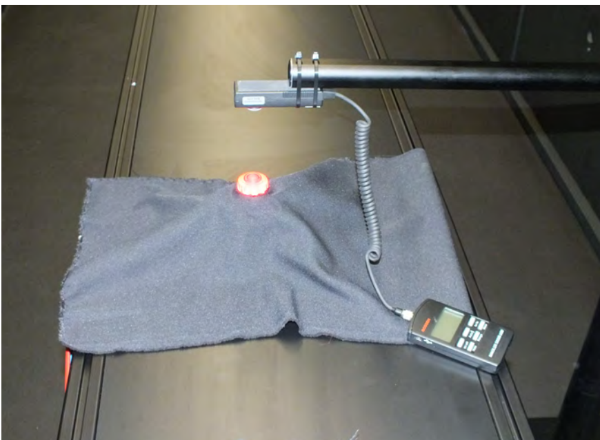
Messaufbau zur Erkennbarkeit von Not-Halt-Geräten im Labor
