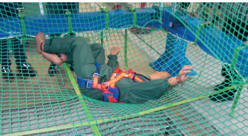
Dummy nach einem Sturz in ein Arbeitsplattformnetz
