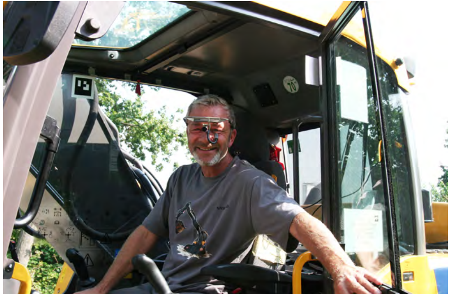
Baggerfahrer mit Blickverfolger „Dikablis“ zur Messung der Blickzuwendungen bei der Arbeit (Bild: Fa. Frauenrath, Heinsberg)
