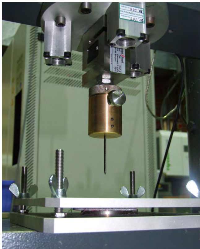
Prüfeinrichtung zur Bestimmung der Durchtrittssicherheit
