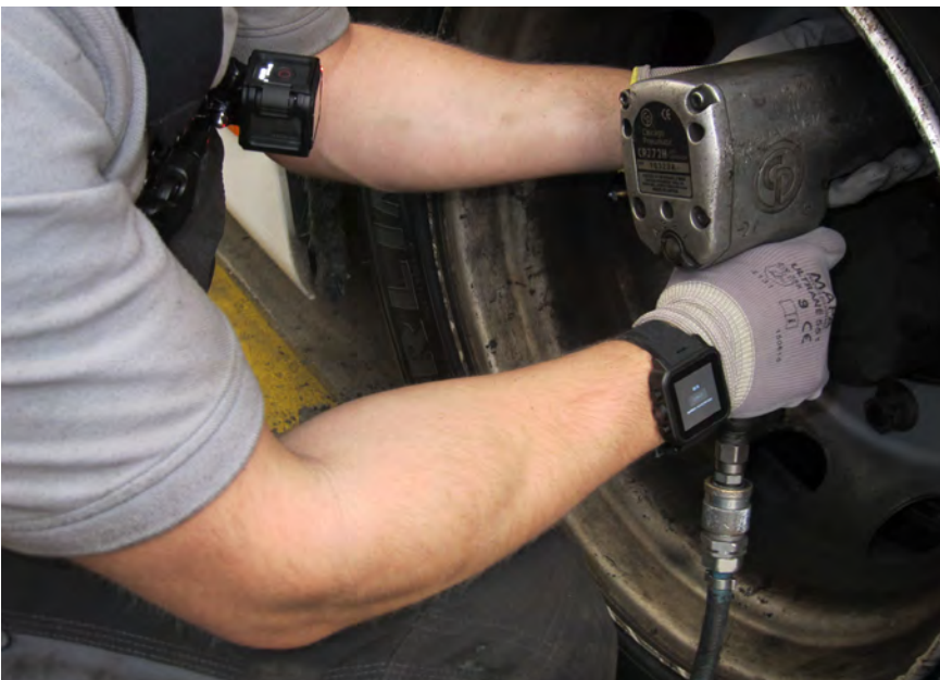
Hand-Arm-Vibration: Erprobung des Einsatzes von Smartwatches zur Gefährdungsbeurteilung
