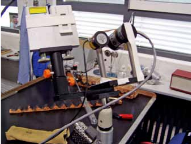
Abbildung 15: Messanbau in der Totalansicht; der Abstand zwischen der Messapparatur und der Gasflamme betrug 50 cm
