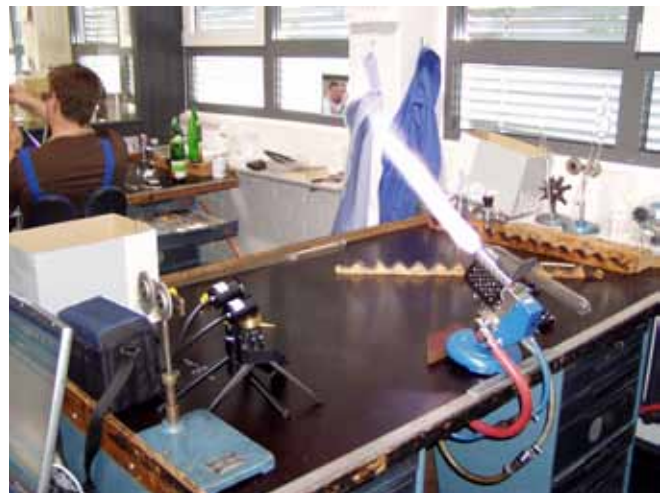
Abbildung 17: Messaufbau zur Messung von Spektren der Gasflamme ohne Werkstück; bei der Messung unter Bearbeitung eines Werkstücks wurden die Eingangsoptiken wie in den Abbildungen 2 bis 4 gezeigt montiert
