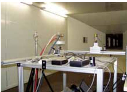
Abbildung 13: Versuchsaufbau für Labormessungen; die Abbildung zeigt beispielhaft die Messung eines Strahlungsspektrums unter den Einstellungen Winkel 90^\circ und Abstand 0,5\text{ m}
