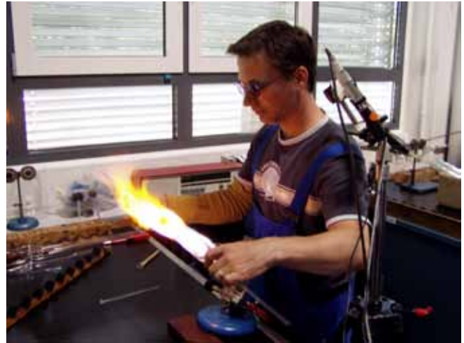
Abbildung 16: Messaufbau während der Glasbearbeitung; Sicht auf das Werkstück wird nicht verdeckt; Position des Aufbaus spiegelt den Ort von Augen und Kopf wider
