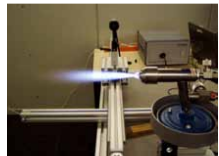
Abbildung 13: Versuchsaufbau für Labormessungen; die Abbildung zeigt beispielhaft die Messung eines Strahlungsspektrums unter den Einstellungen Winkel 90^\circ und Abstand 0,5\text{ m}
