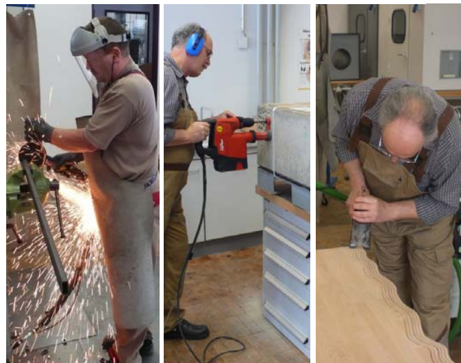
Arbeitsplätze mit Schleifer, Bohrhammer und Stichsäge im Ringversuch
