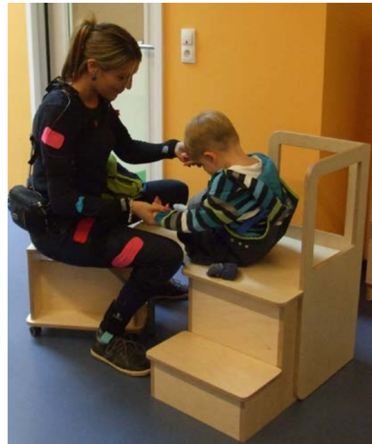
Erzieherin mit CUELA-Messsystem bei Nutzung einer neu entwickelten Anziehhilfe, Quelle: Unfallkasse Rheinland-Pfalz
