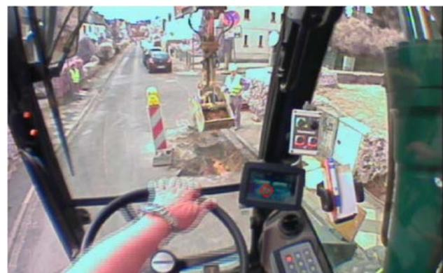
Der mobile Blickverfolger „Dikablis“ zur Messung der Blickbewegungen (oben, Quelle: Ergoneers GmbH, Manching). Aufnahme im Bagger: das rote Fadenkreuz zeigt die Blickzuwendung auf dem Monitor an (unten).
