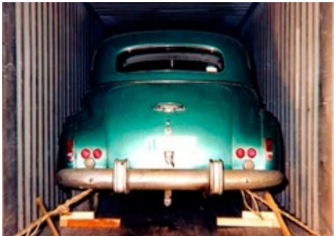
Abb. 5 Stauung mit großem Freiraum – leicht zu lüften
