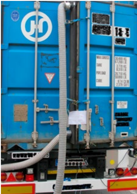
Abb. 7 und 8 Technische Lüftung eines Frachtcontainers
