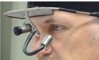
Mit einem Eyetracking-System werden die Bewegungen der Augen erfasst und aufgezeichnet. Es besteht aus einem Kopfband, und einem Nasenbügel (ähnlich dem einer Brille) und zwei kleinen Kameras. Eine Kamera ist auf eines Ihrer Augen, die andere Kamera auf den Bereich vor Ihnen gerichtet. Im ersten Augenblick mögen die Kameras störend wirken, dieser Eindruck verflüchtigt sich jedoch bereits nach wenigen Minuten.
