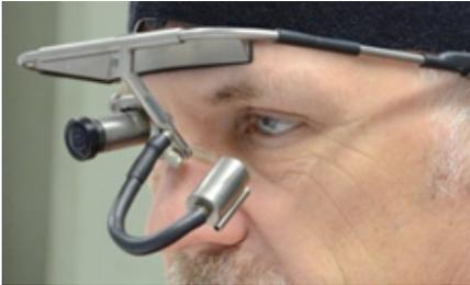
Das System besteht aus zwei kopfbasierten Kameras, von denen eine schräg von unten das Bild des linken Auges und eine zweite Kamera das Szenenbild vor der Person aufzeichnet. Die Szenenkamera ist aufgrund ihrer Position nahe der Nasenwurzel für die Testperson fast nicht sichtbar. Die Augenkamera mit 50-Hz-Aufnahmefrequenz befindet sich am unteren Rand des Sichtfeldes des linken Auges und wird nach einiger Zeit der Gewöhnung kaum noch wahrgenommen.
