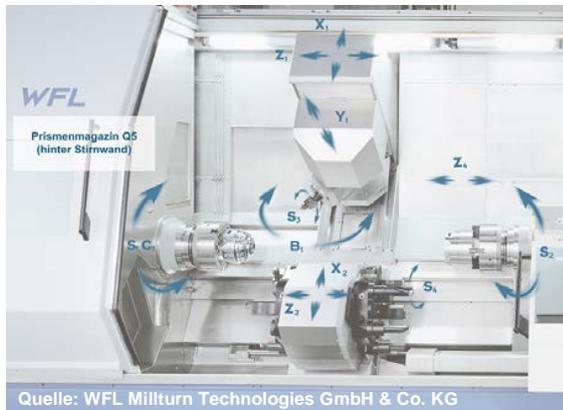
**Bild 1:** Achsschema einer Werkzeugmaschine
