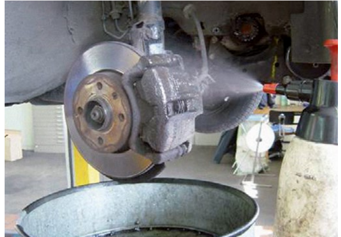
Abb. 17-7 Besprühen eines Bremssattels
