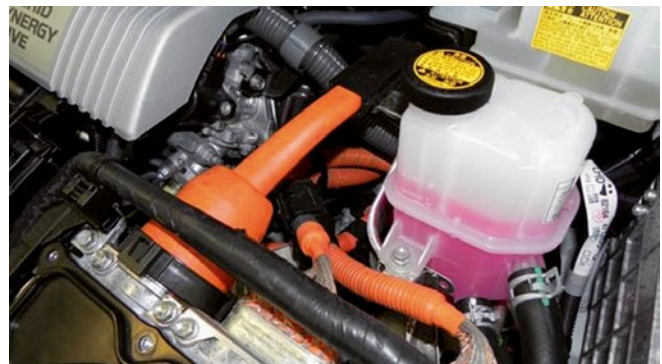
Abb. 8-1 Orange gekennzeichnete HV-Kabel
