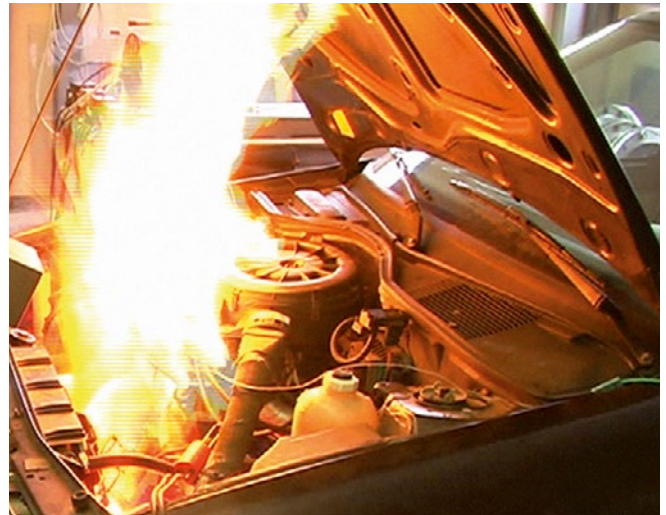
Abb. 17-5 Explosion/Verpuffung im Motorraum
