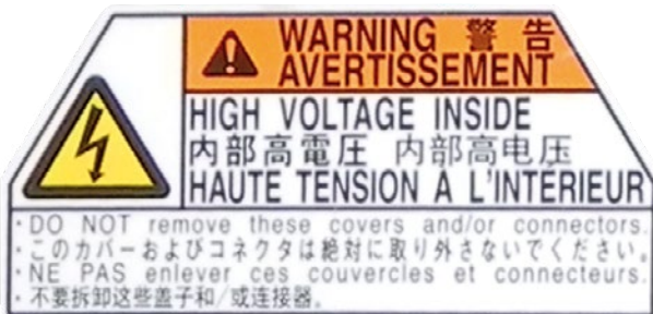
Abb. 8-2 Beispiel einer Kennzeichnung von HV-Komponenten
