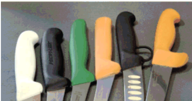
Abb. 16: Verschiedene Griffstypen verhindern Abrutschen auf die Schneide
