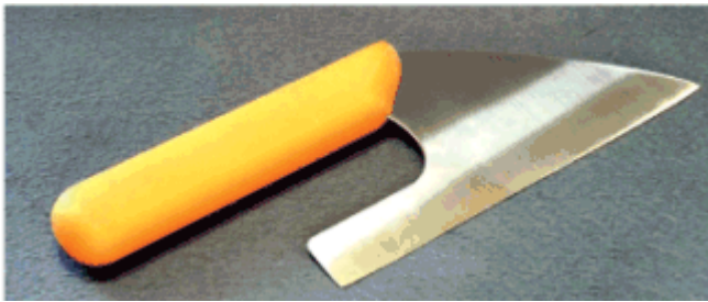
Abb. 18: Entvliesmesser wird von der materialhaltenden Hand und vom Körper weg geführt und reduziert Schnittwahrscheinlichkeit und bietet ergonomische Vorteile
