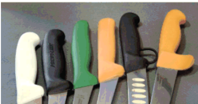
Abb. 16: Verschiedene Griffotypen verhindern Abrutschen auf die Schneide
