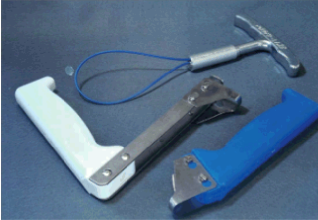
Abb. 11: Rippenzieher mit Spezialklinge verhindert Stich und weitgehend Schnitt
