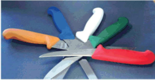
Abb. 17: Verschiedene Farben ermöglichen Zuordnung zu Arbeitsbereichen, Personen oder zu hygienisch unterschiedlich sensiblen Bereichen
